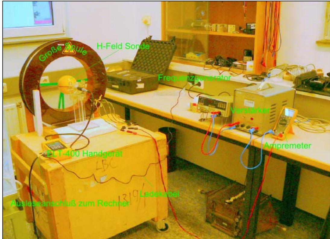
**Abbildung 4.3.1:** Messaufbau für magnetische Feldmessung im Spulenmittelpunkt. An gleicher Stelle in der Spule werden nacheinander die weiteren Feldsonden positioniert.
