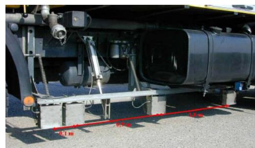
Abbildung 2-24: Messvorrichtung des RoadSTAR [21].
