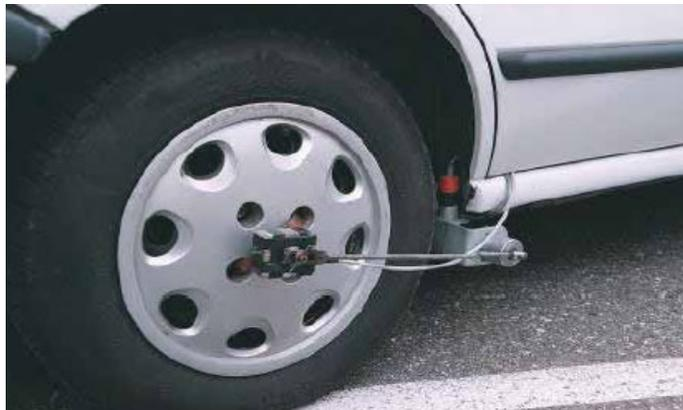
Abbildung 2-20: Befestigung des Differentialumwandlers am Fahrzeug [10].
