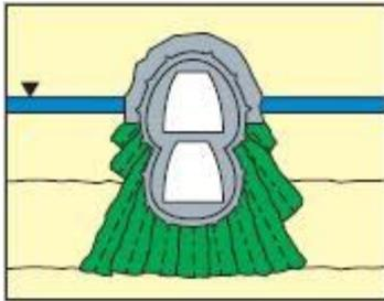
DSV- Tunnelschalen werden vorzugsweise in Lockergesteinen unter oder neben gefährdeten Gebäuden ausgeführt.
