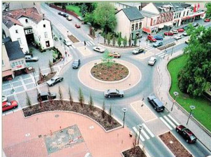
Abb. 57: Umbau der Kreuzung zu einem Kreisverkehr. Das Resultat ist mehr Platz (ca.30%) und gestalterische Elemente [29]
