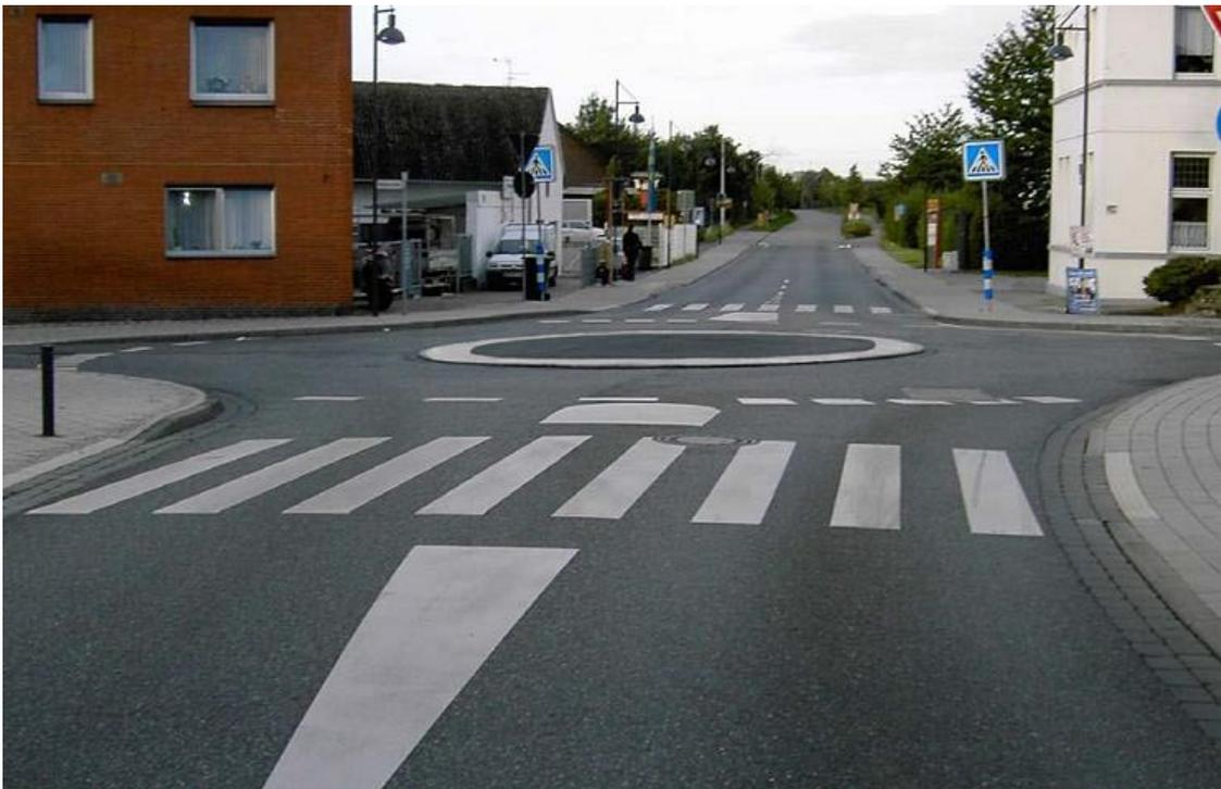
Abb. 35: Mini-Kreisverkehr. Kreisinsel ist aus Asphalt gemacht. Man sieht klar die Höhe der Bordstein. [8]
