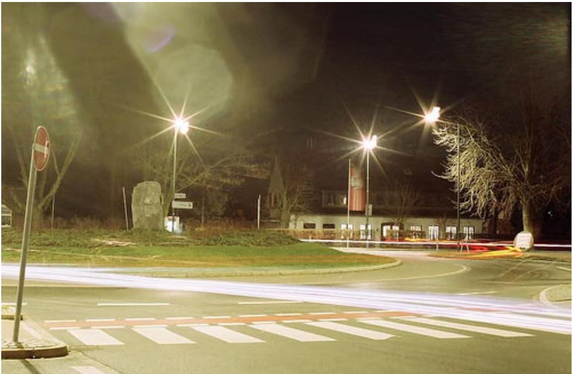
Abb. 6: Beleuchtung von dem Außenrand der Kreisfahrbahn [27]
