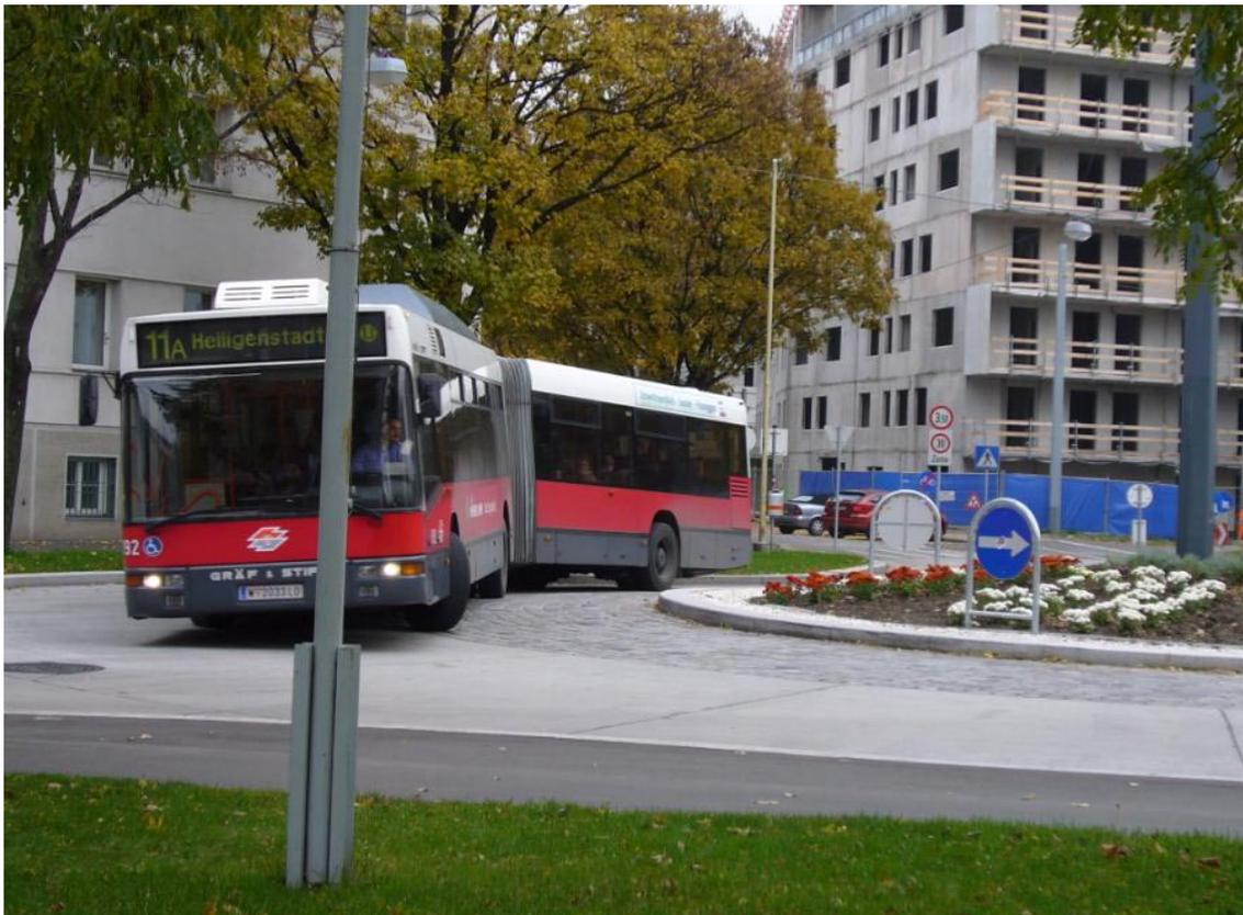
Abb. 78: Schleppkurve des Linienbusses 11A. Dieser Bus benutzt nicht die ganze Außenringbreite, ist in diesem Fall auch nicht nötig. [eigenes Photo]
