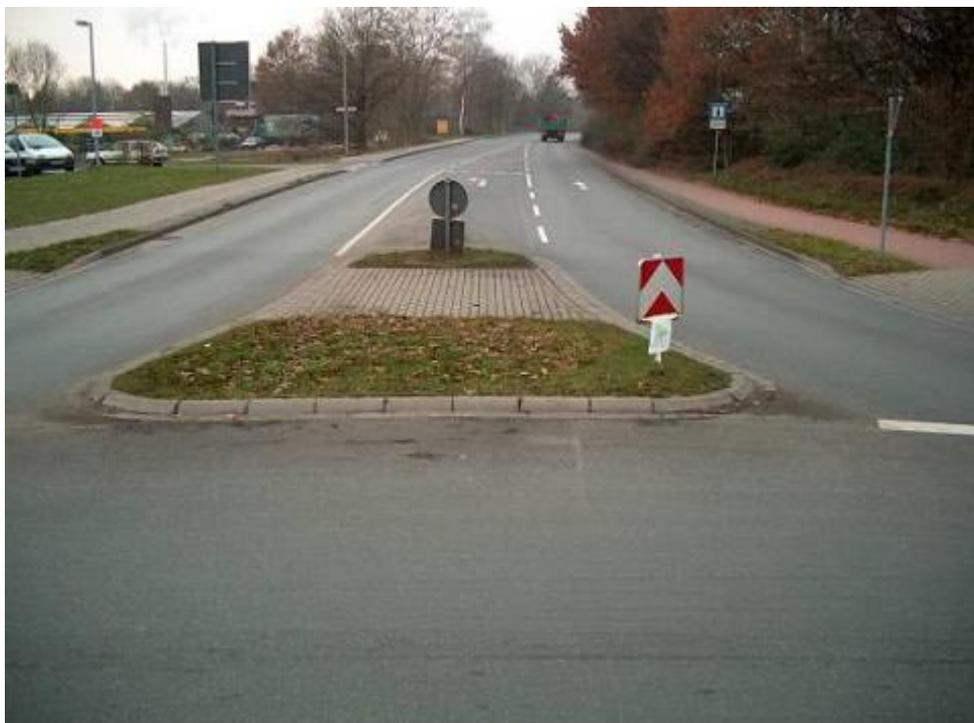
Abb. 44: Bepflanzte Fahrbahnteiler mit Querungshilfe für Fußgänger [10]
