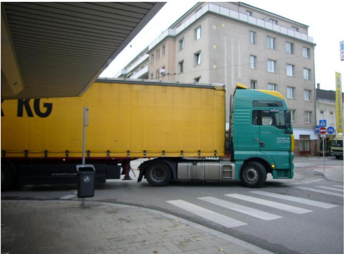
Abb. 74: Schleppkurve eines rechtsabbiegenden LKW [eigenes Photo]
