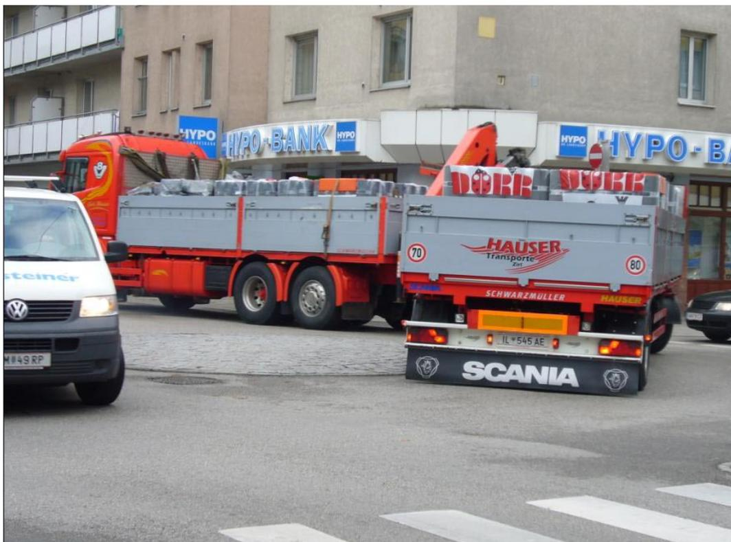
Abb. 68: Schwerfahrzeug fährt durch den Kreisverkehr. Es benutzt die ganze Fahrbahnbreite mit dem Resultat, dass nur ein kleiner Teil der Kreisinsel mitbenutzt wird. [eigenes Photo]
