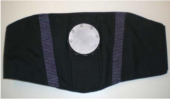
Abbildung 43: Sensorgehäuse angenäht auf dem Nierengürtel (Ansicht von oben ohne Silikon Schlagpilz)
