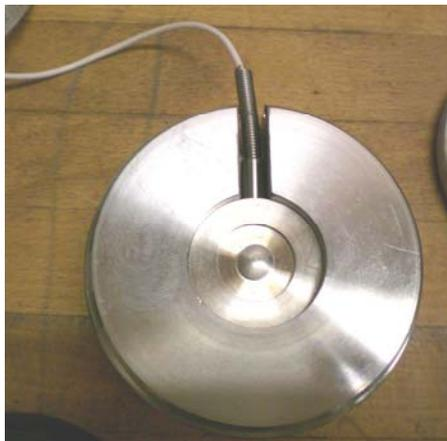
Abbildung 27: Kraftmessdose eingebettet in einer Stahlkonstruktion
