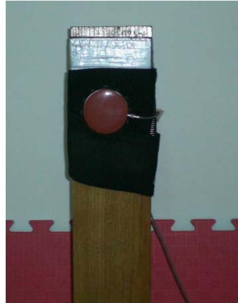
Abbildung 44: Kraftsensor auf Makiwara (Holzbrett mit Hartgummi, Ansicht von vorne)
