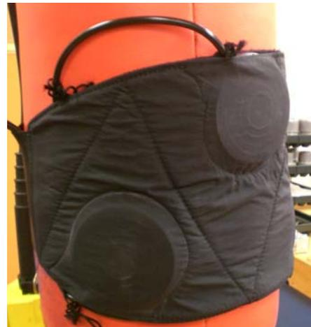
Abbildung 31: Nierengurt mit Luftschalter am Boxsack
