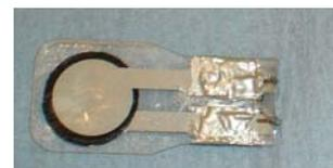
Abbildung 40: Geklebte Drähte am FSR Sensor
