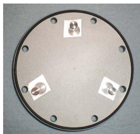
Abbildung 35: Sandgestrahlte obere Platte des Drucksensors
