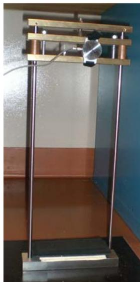
*Abbildung 18: eingespanntes Sensormodul in Richtung der  $y$ -Achse*
