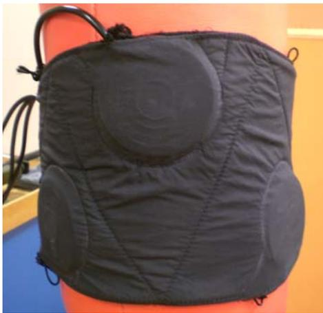
Abbildung 30: Nierengurt mit Luftschalter am Boxsack
