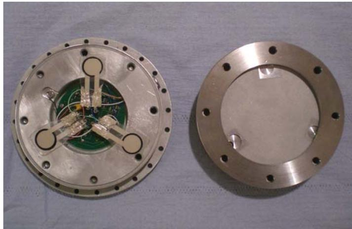
Abbildung 41: Sensorgehäuse und Sensorauflage
