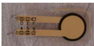
Abbildung 39: Gekürzter FSR Sensor mit Drähten
