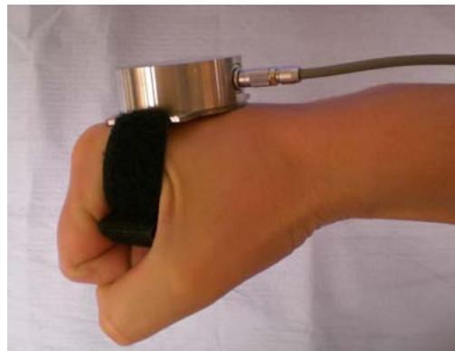
Abbildung 12: Anbringungsmöglichkeit des Beschleunigungsmoduls
