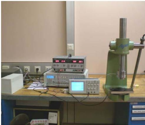
Abbildung 25: Messaufbau für die statische Druckmessung
