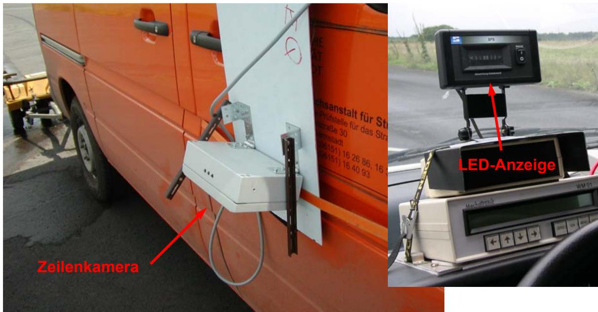
**Abbildung 6-6:** Neues Spurführungssystem RV 2004
