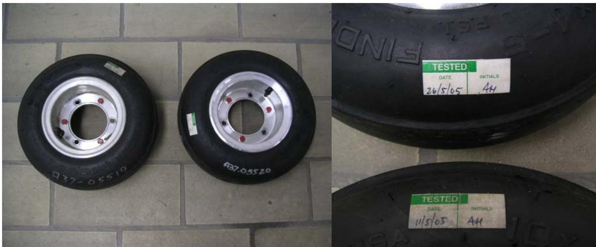
**Abbildung 7-18:** Messreifen A37-05519 und A37-05520 für Referenzmessungen
