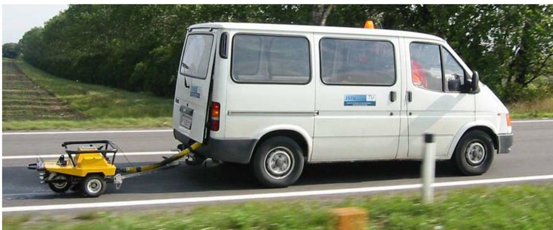
**Abbildung 3-12:** GripTester im Zugbetrieb [53] [54]
