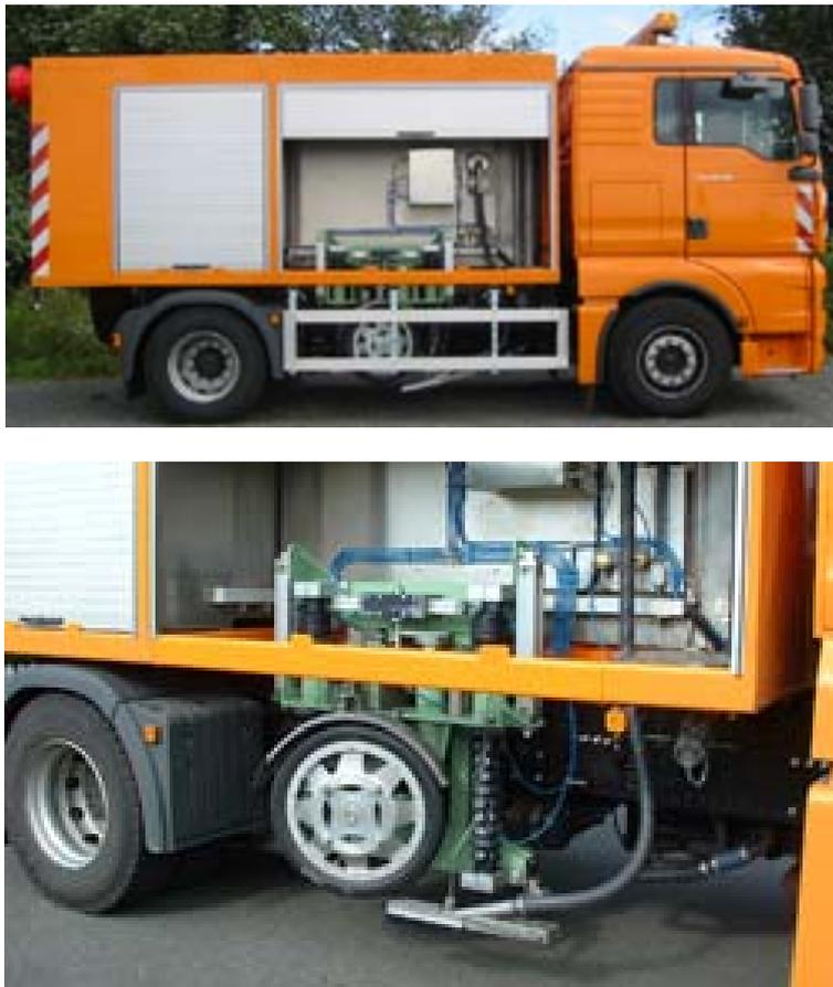
**Abbildung 3-28:** Seitenkraftmessverfahren SKM [64]
