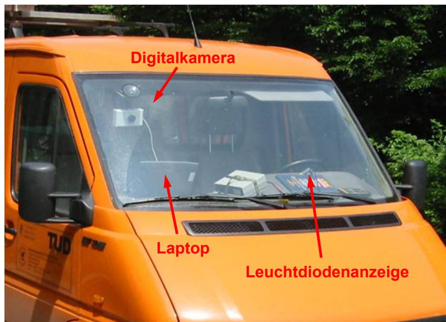
**Abbildung 6-2:** Spurführungssystem RV 2002
