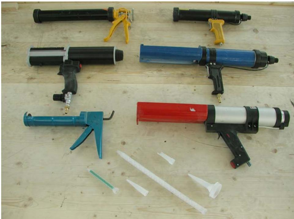
Abbildung 25: Diverse Kartuschenpressen und Mischdüsen für den Hand- oder Druckluftbetrieb
