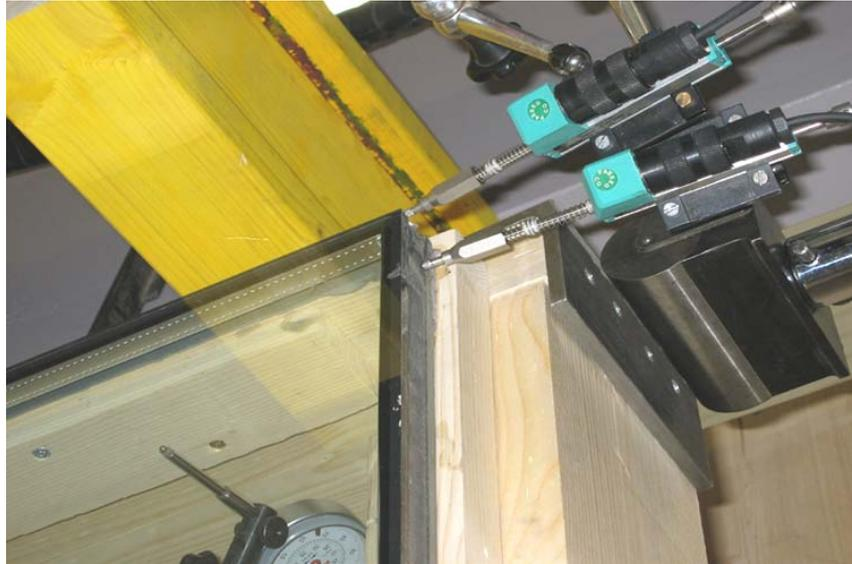
**Abbildung 83: Prüfaufbau Detail C – Kräfteinleitungspunkt (Weg D2, D3 und A3)**
