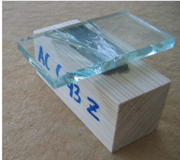
**Abbildung 33: Unerwünschter Biegebruch im Glas**
