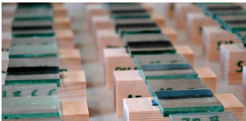
**Abbildung 2: Probekörper für die Bruchversuche und Klimabelastungsversuche**
