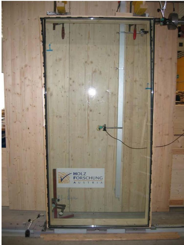
**Abbildung 103: Versagen der Klebefuge bei Volllast – die Verklebung der unteren Verbundelementhälfte bleibt weitestgehend intakt**
