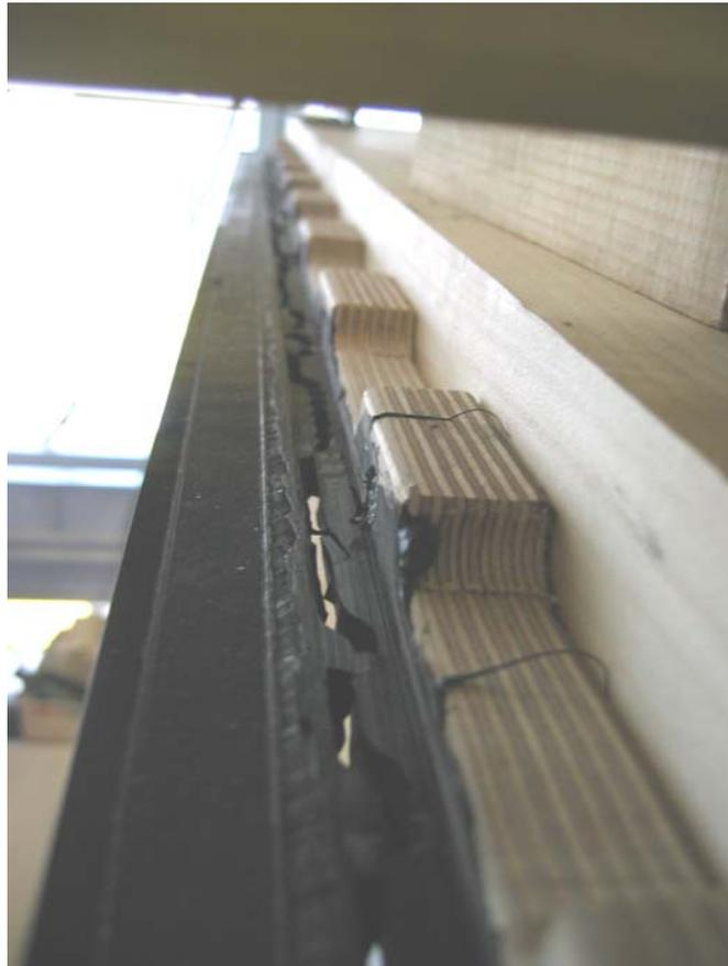
**Abbildung 100: Kohäsionsbruch in der Klebefuge – Kopfschwelle**
