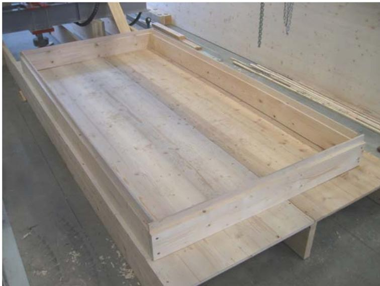
Abbildung 70: Herstellung der Hauptrahmen auf dem Richttisch (hier Prototyp P2)
