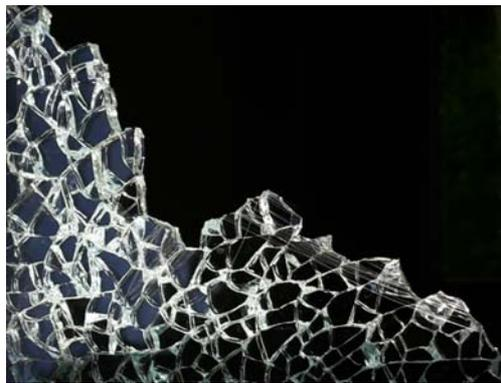
Abbildung 3: Bruchbild von vorgespanntem Glas
