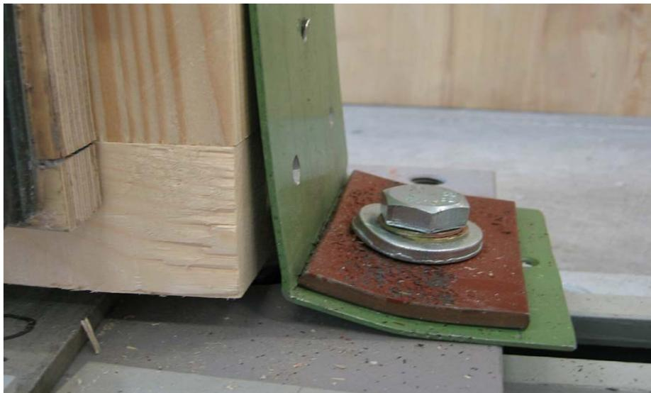
**Abbildung 106: Versagen der Zugverankerung – Quadrant IV**
