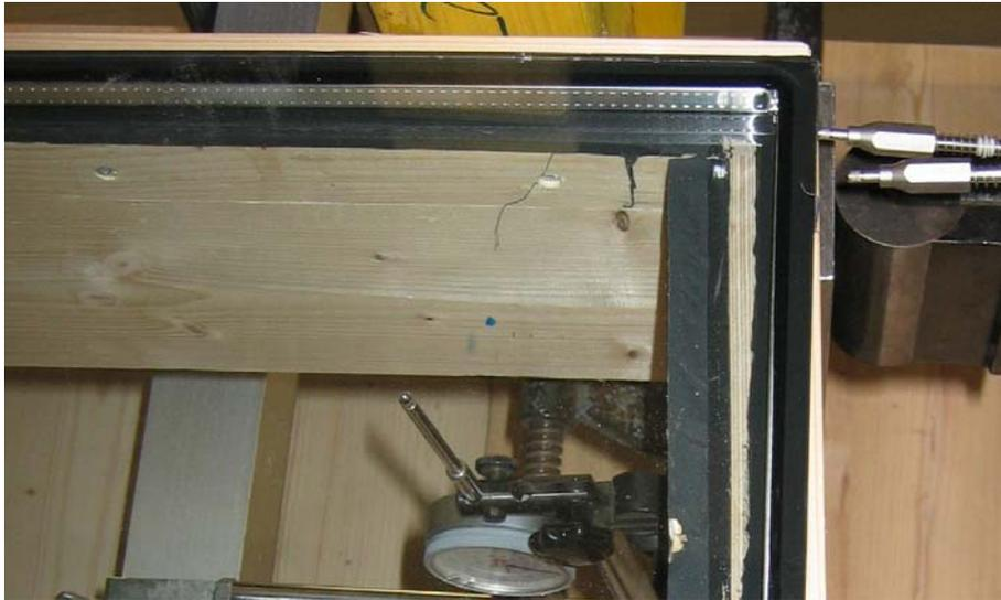
**Abbildung 95: Kohäsionsbruch in der Klebefuge – Quadrant II**
