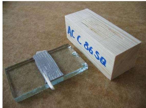
**Abbildung 28: Mischbruch aus Adhäsionsversagen KH und Kohäsionsversagen HH**
