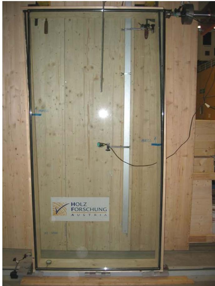
**Abbildung 97: Anriss bei der Kraftereinleitung – die Verklebung in der unteren Elementhälfte bleibt intakt**
