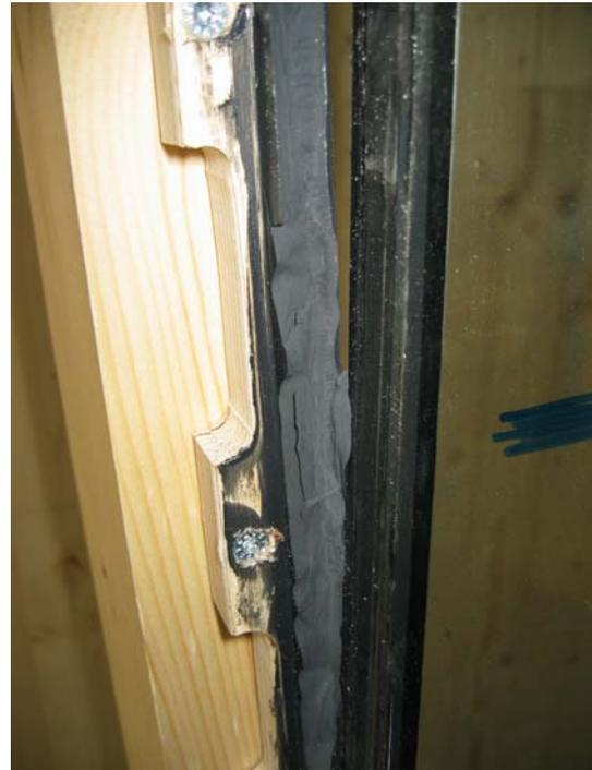
**Abbildung 102: Kohäsionsbruch der Klebefuge – Stiel Quadrant II**
