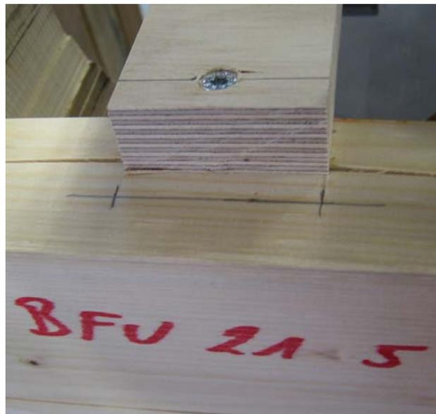
**Abbildung 124: Versagensform d) nach Abbildung 125 der Koppelrahmenverschraubung im Vorversuch**
