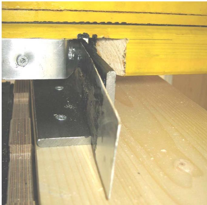
**Abbildung 87: Prüfaufbau Detail D – Gleitführung der Kopfschwelle (Lager C und D)**
