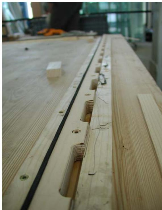
**Abbildung 72: Detail – aufgespannter Koppelrahmen**
