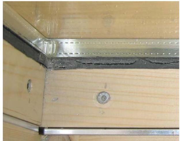
Abbildung 92: Kohäsionsbruch in der Klebefuge – Quadrant IV
