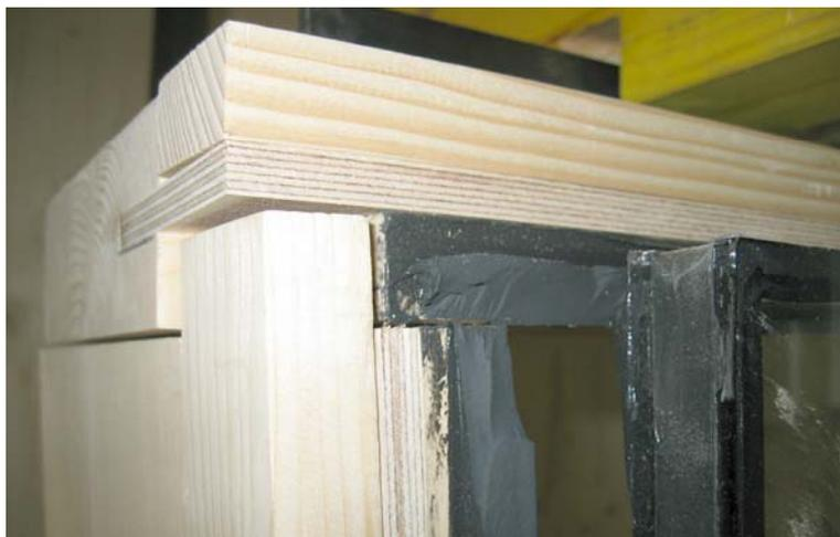
**Abbildung 96: Kohäsionsbruch in der Klebefuge – Quadrant II**
