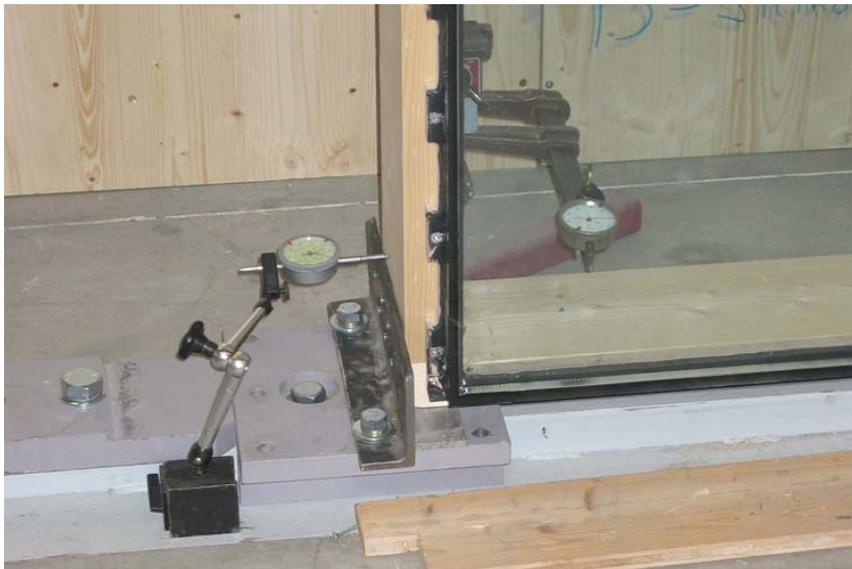
**Abbildung 84: Prüfaufbau Detail A – Fixpunktmessung am Festlager (Weg A1 und A2, Lager A)**
