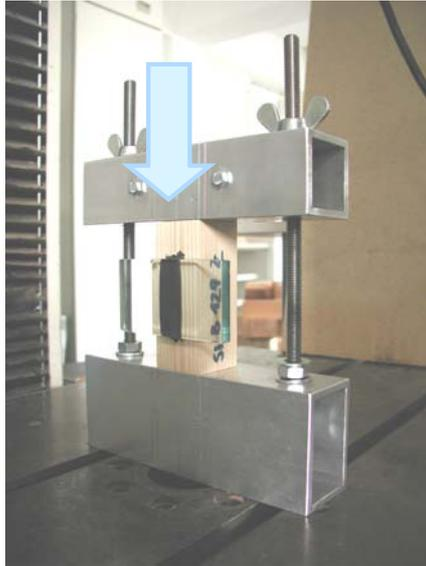
**Abbildung 31: Einspannvorrichtung für Schubversuche, parallel zur Klebefuge**
