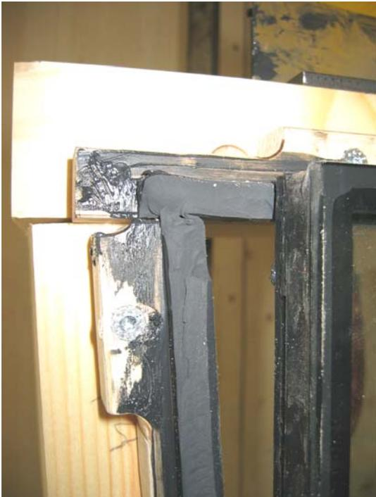
**Abbildung 101: Kohäsionsbruch der Klebefuge – Ecke Quadrant II**
