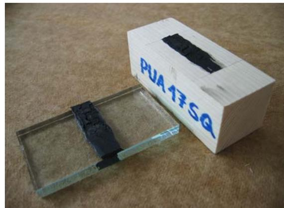
**Abbildung 29: Mischbruch - hauptsächlich Kohäsionsversagen KK**
