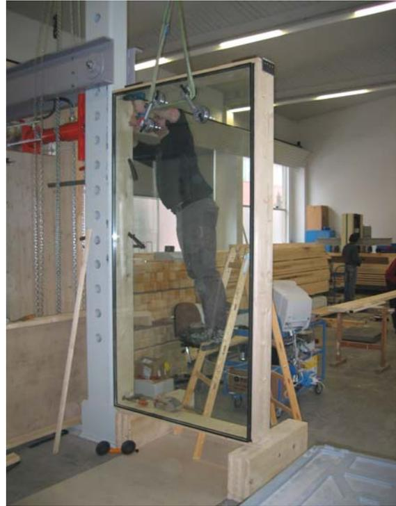
Abbildung 75: Montage des Verbundelementes
