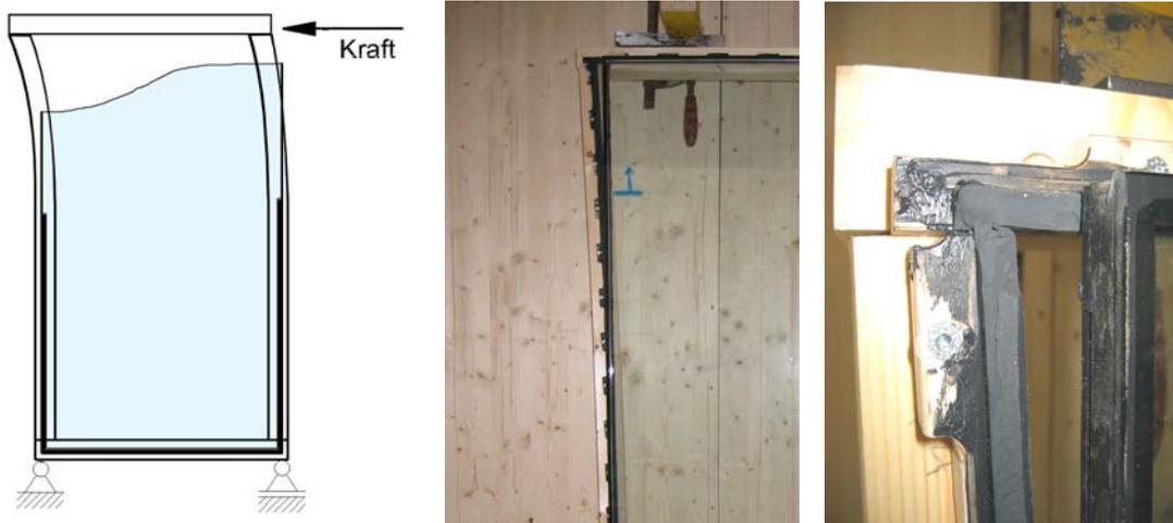
**Abbildung 123: Versagen der Klebefuge mit Aktivierung der Biegesteifigkeit des Hauptrahmenstieles**
