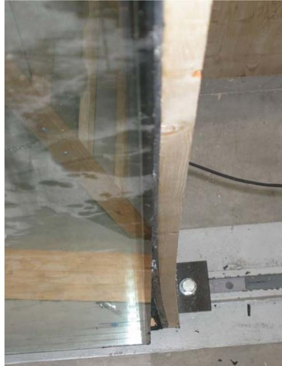
Abbildung 113: Biegung des rechten Stieles bei Vollast – Quadrant IV
