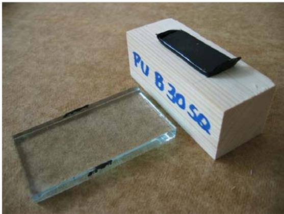
**Abbildung 26: Adhäsionsbruch GK**
