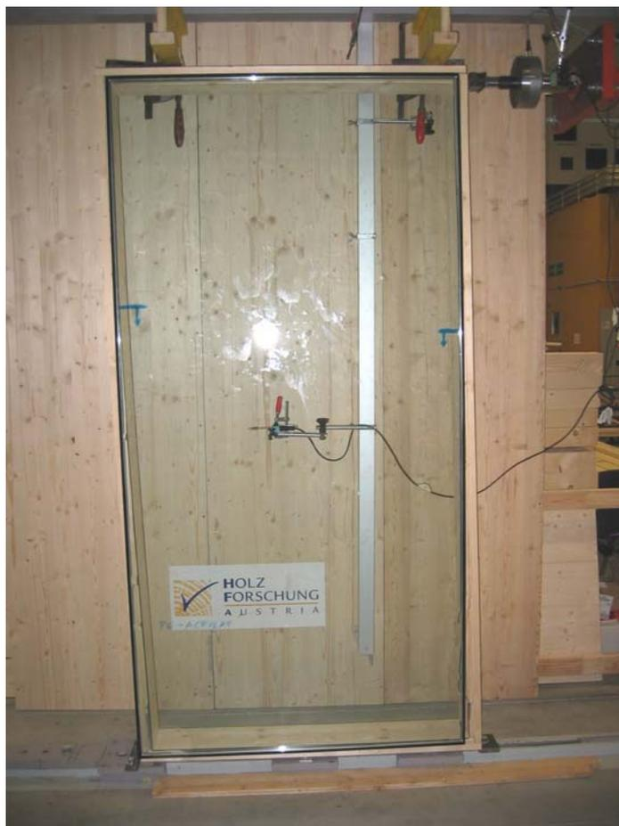
**Abbildung 118: Versagen des Verbundelementes im unteren Bereich**
