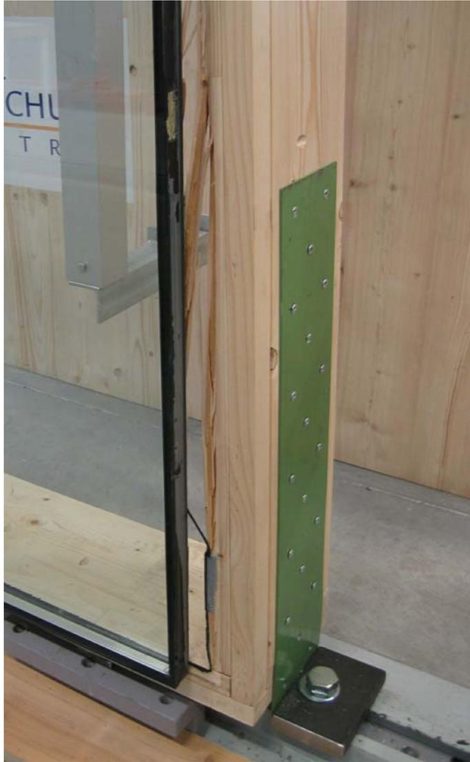
**Abbildung 117: Holzbruch bei der Zugverankerung in Quadrant IV**
