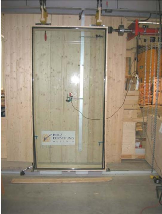
Abbildung 112: Prototyp versagt im unteren Bereich
