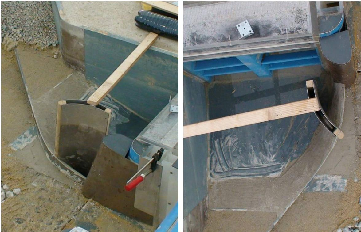
**Abb. 3.51: Neuer Vorboden (Typ2), kurzer Trennpfeiler nach Rouvé (R1) und langer Leitwand (LW2)**
