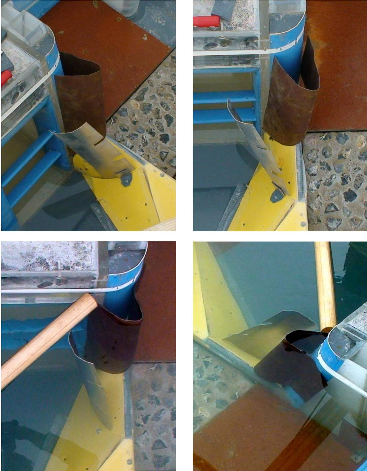
**Abb. 3.45: Vertikale Blechleitwand (LW1) und verlängerter Pfeiler (R0)**
