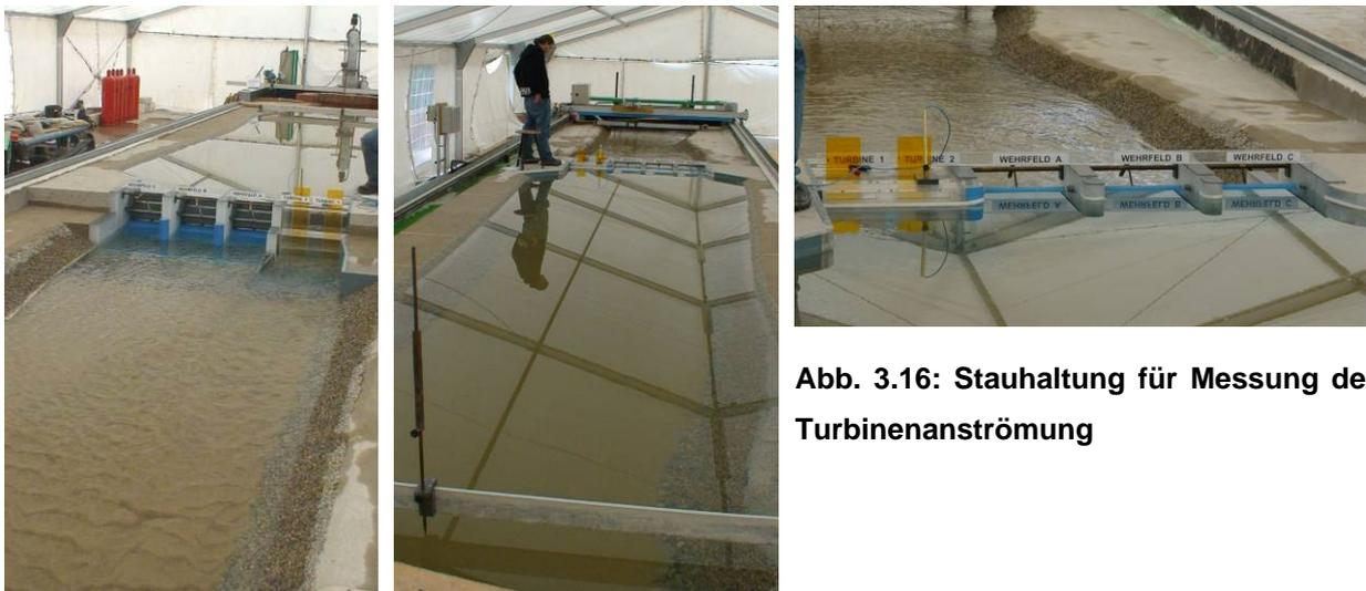
Abb. 3.16: Stauhaltung für Messung der Turbinenanströmung
