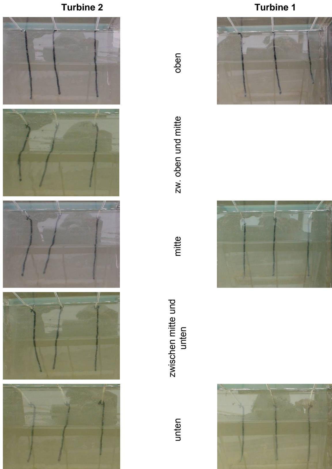
**Abb. 3.17: Strömungsbedingungen Turbine 2 und 1 beim Urplanungszustand ohne Rechenträger (Fließrichtung von oben nach unten)**
