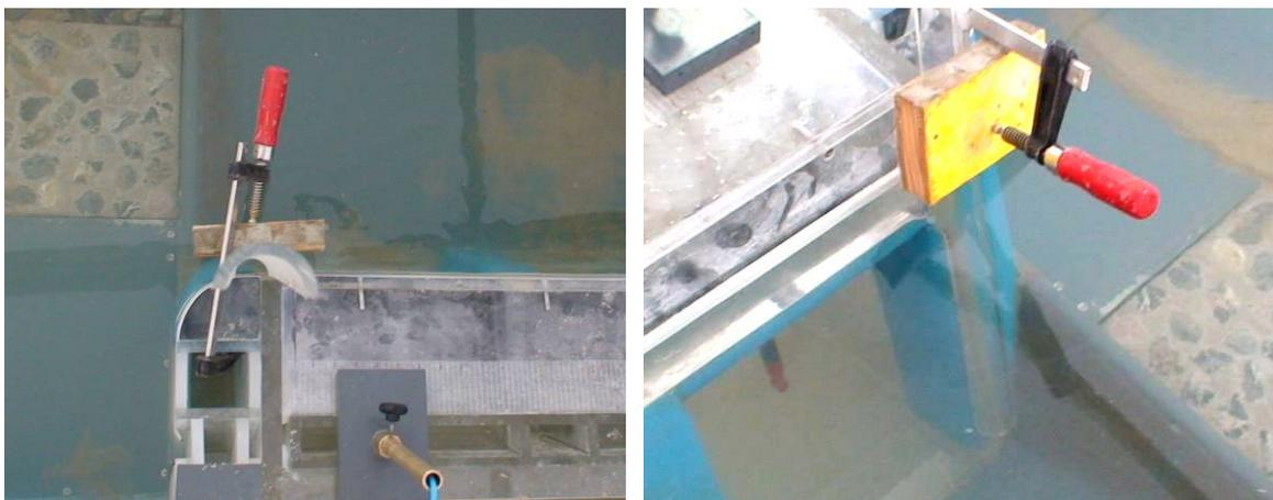
**Abb. 3.24: Nase an der Innenkante des ursprünglichen Pfeilers (Typ1)**
