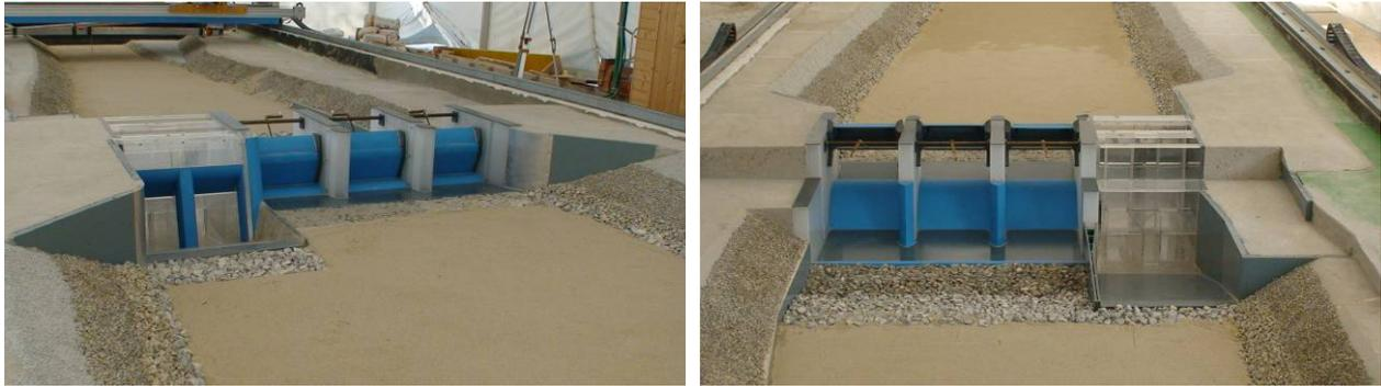
Abb. 3.15: Turbineneinlauf und Wehrfelder Ansicht OW (links) und UW Ansicht (rechts)
