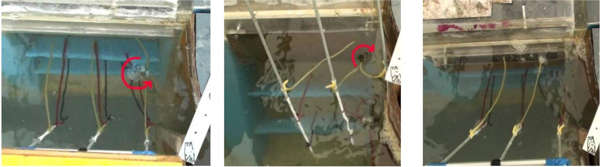
**Abb. 4.13: Vergleich Wirbelbildung bei Verwendung der Injektoren (ohne, 0,4m Öffnung, 0,8m Öffnung)**
