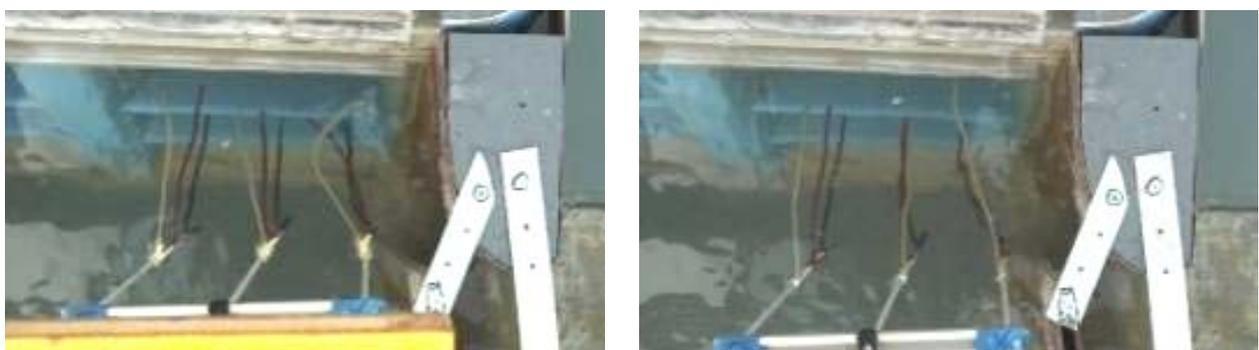
**Abb. 3.74: R4 und Leitwand (LW5) – Stromfäden vor Rechenebene T2 2MB (32 l/s)**
