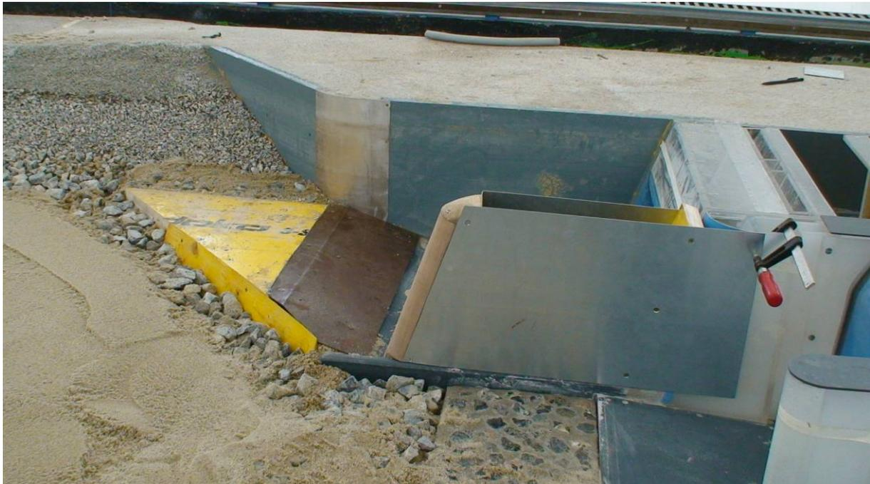
**Abb. 3.22: Neue Geschiebeschwelle und längerer Trennpfeiler**
