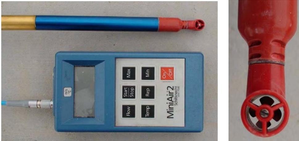
Abb. 3.13: Geschwindigkeitsmessflügel
