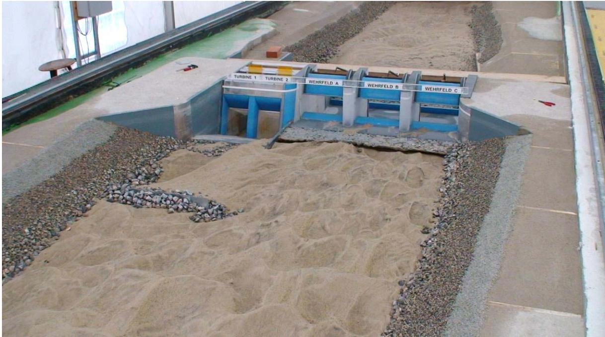
**Abb. 3.8: Riffelbildung bei Verwendung des feinen Modellsandes**
