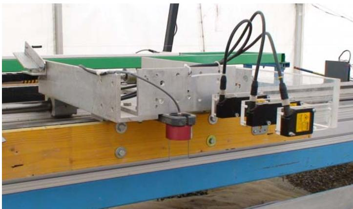
Abb. 3.11: Messwagen mit Laser- und Ultraschallsonden
