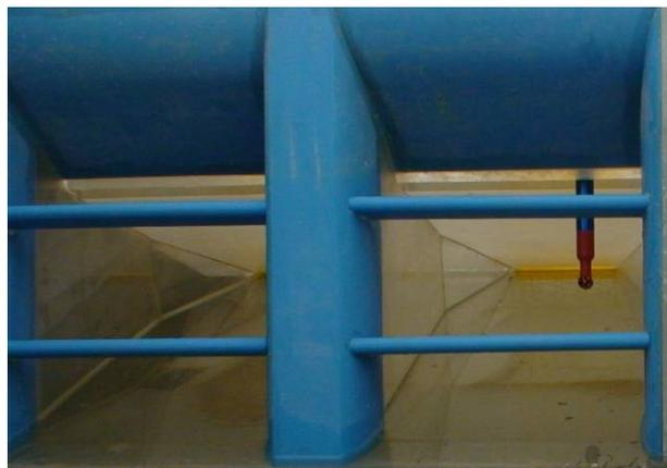
**Abb. 3.29: Turbineneinlauf mit eingebauten Rechenträgern**
