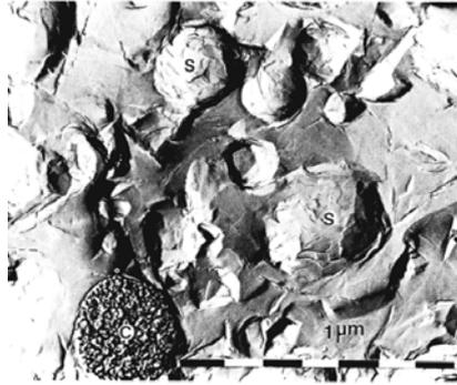
**Abbildung 51: Wassertröpfchen in Margarine / TEM (Oberflächenabdruck)**
