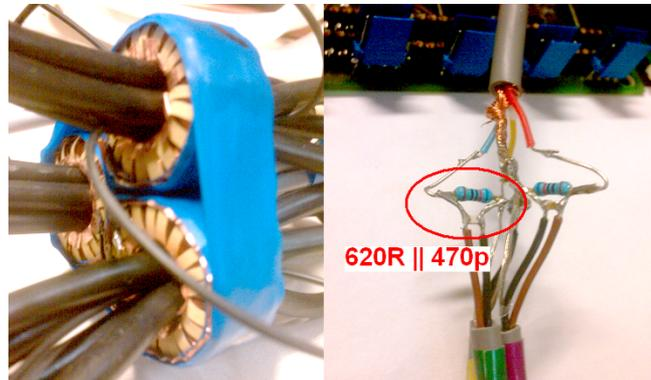
Abbildung 4.18: Spule 4 in der gleichtaktunterdrückenden (li.) Schaltung; Bedämpfung am Ende der Messleitung (re.)
