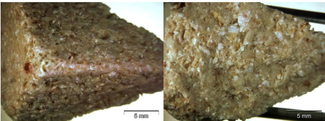
*Abbildung 14: Probe 20 Außenseite (links) und Bruchfläche (rechts) nach 2 Jahren*
