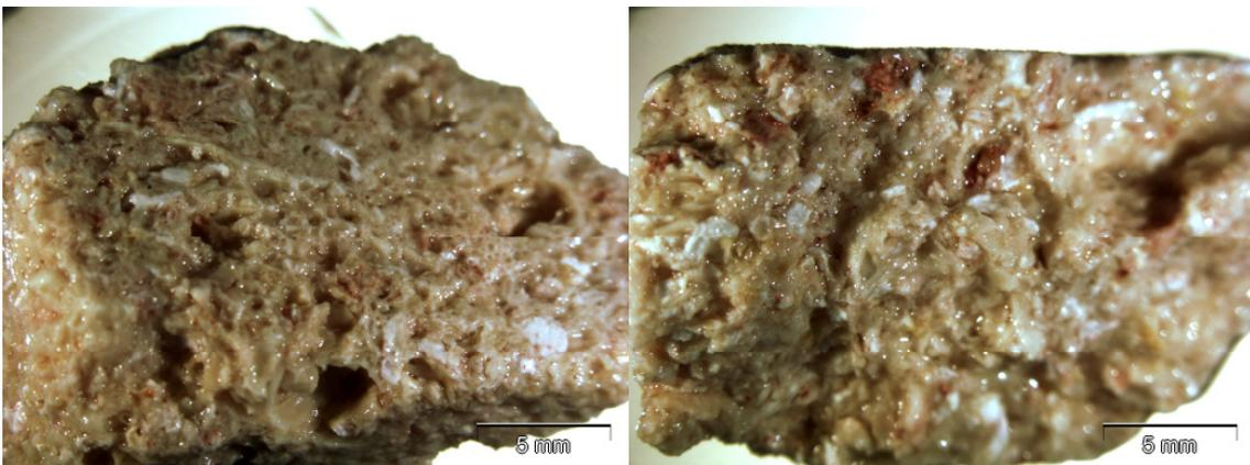
*Abbildung 10: Probe 16 Außenseite (links) und Bruchfläche (rechts) nach 2 Jahren*
