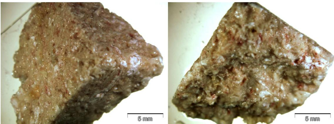
*Abbildung 11: Probe 17 Außenseite (links) und Bruchfläche (rechts) nach 2 Jahren*
