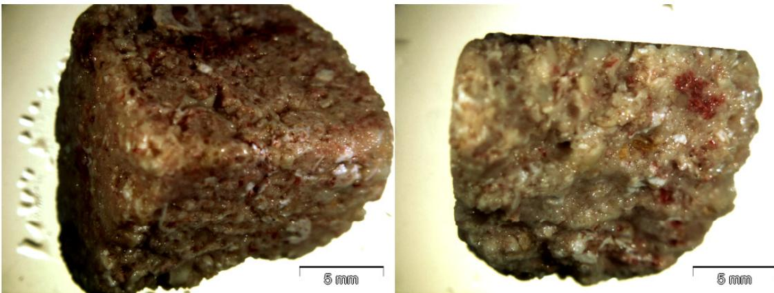
*Abbildung 25: Probe 05 Außenseite (links) und Bruchfläche (rechts) nach 2 Jahren*
