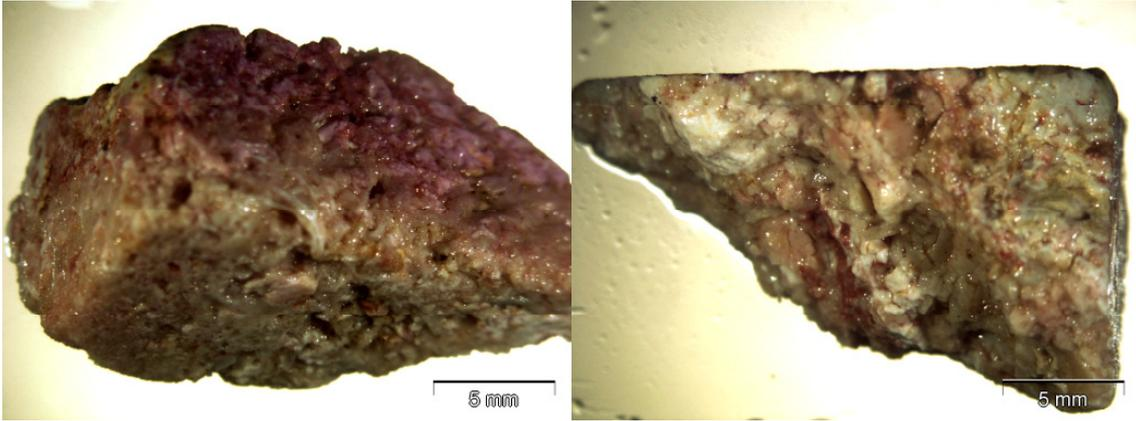
*Abbildung 24: Probe 03 Außenseite (links) und Bruchfläche (links) nach 2 Jahren*
