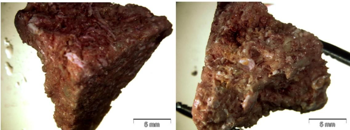
*Abbildung 29: Probe 10 Außenseite (links) und Bruchfläche (rechts) nach 2 Jahren*
