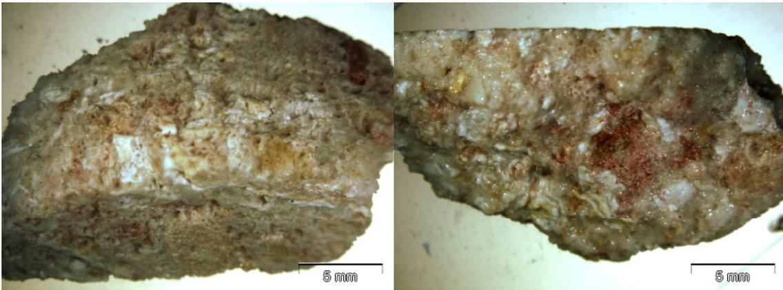
*Abbildung 6: Probe A2 Außenseite (links) und Bruchfläche (rechts) nach 2 Jahren*
