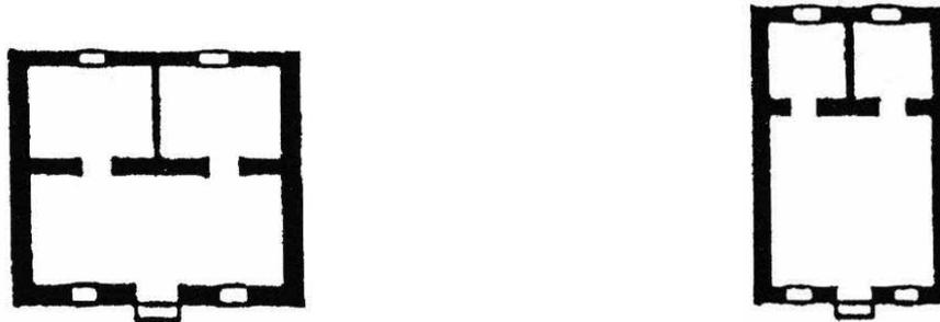
Abb. 422: Varianten des Hauses mit Hauptraum und dahinter liegenden Doppelräumen: Grundriss-Schemata
