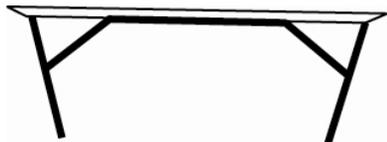
Abbildung 1.2 Sprengwerk
