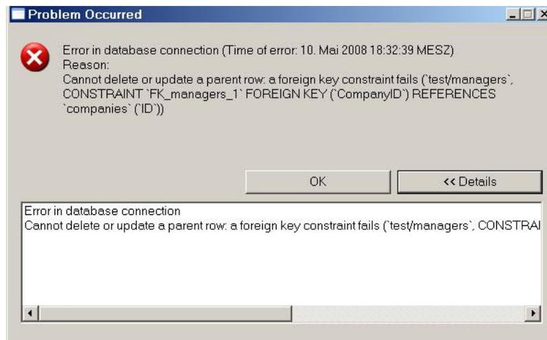
Abbildung 7.32 - Fehlerdarstellung in GDCF: Datenbankfehler
