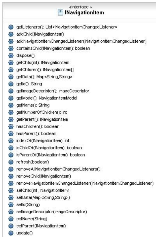
**Abbildung 7.5 - INavigationItem-Klassendiagramm**
