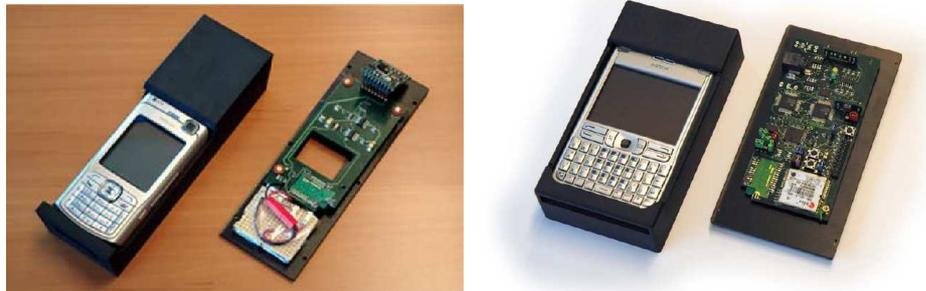
**Abbildung 2.9:** Links ist ein Sensormodul mit Orientierungs- und Neigungssensoren für ein Nokia N70, rechts eines, das zusätzlich einen GPS-Empfänger auf der Platine integriert hat, für ein Nokia E61.
