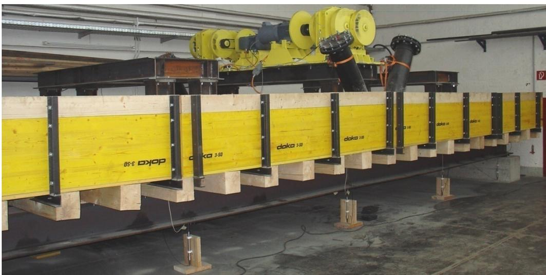
**Abb. 5.9** Blick auf die Versuchsbrücke mit den Unwuchterregern und den TLCD
