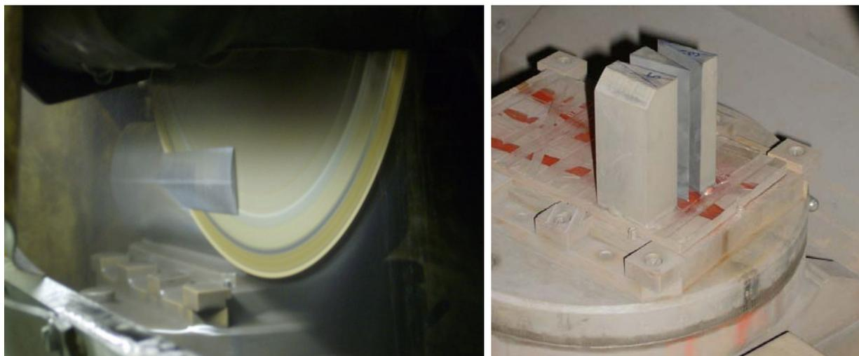
Abbildung 3.2: links: Schleifvorgang; rechts: Si-Kristall auf Goniometer
