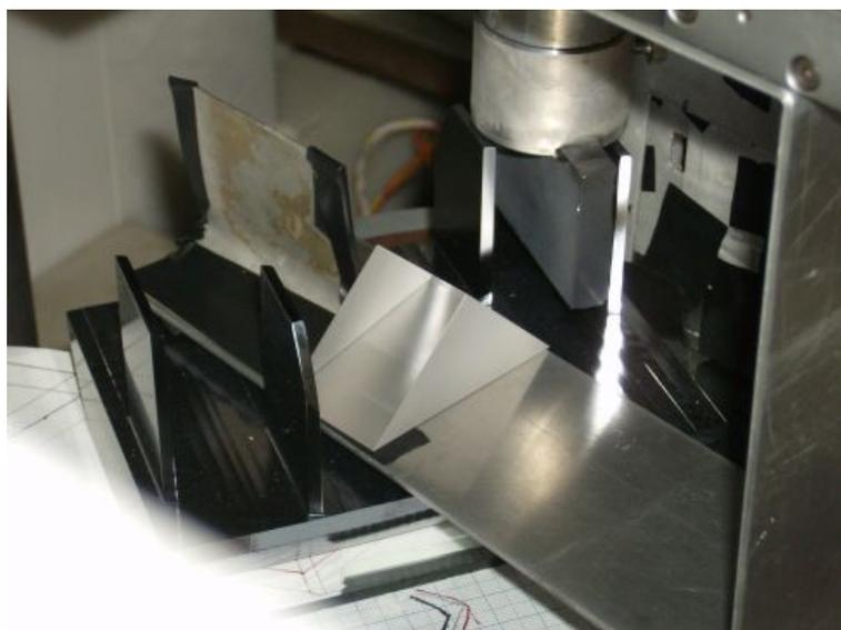
Abbildung 3.6: Messung des Transmissionsvermögens mit Suprasilprisma und Cd-Abschirmung im Interferometer
