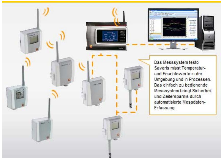
Abbildung 42: Typisches System der Firma Testo [56]
