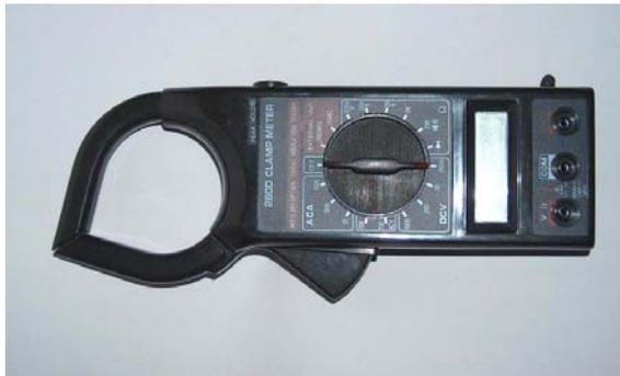
Abbildung 23: Messgerät Stromzange [41]
