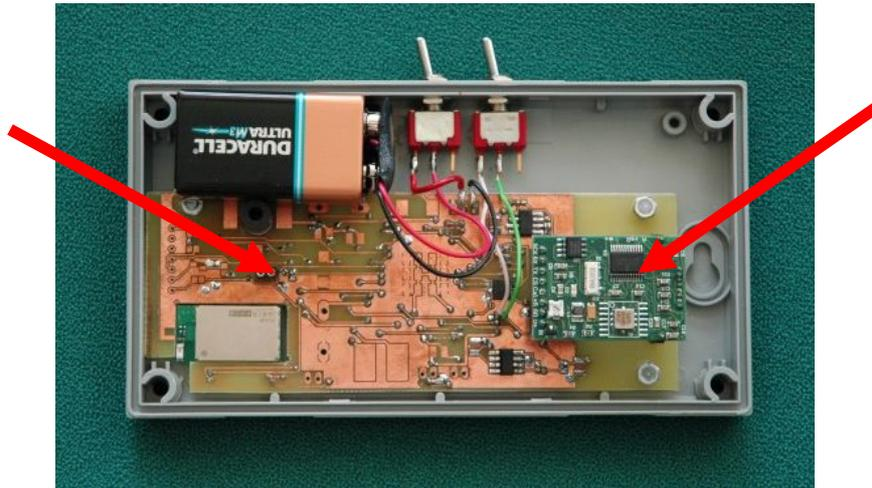
*Abbildung 10: Das für die Entwicklung und die Tests verwendete Sensormodul. Der linke Pfeil zeigt auf das Bluetoothmodul. Der rechte Pfeil zeigt auf den eigentlichen Sensor. Beide konnten einzeln ein- und ausgeschaltet werden.*
