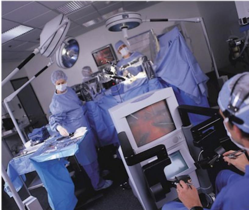
**Abb. 6.17:** ZEUS System während einer Operation
