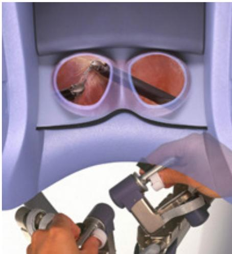
**Abb. 6.16:** Da Vinci Steuerkonsole und 3-D Sicht
