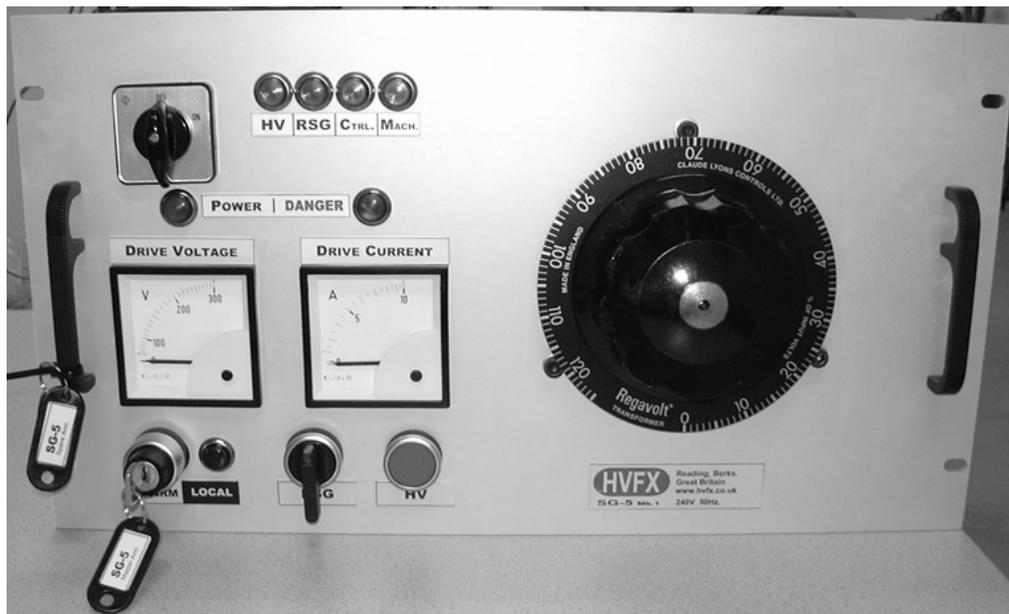
Abb. 6-1: separate Ansteuereinheit für den Teslatrafo SG-5
