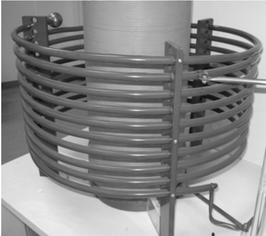
Abb. 3-9: Primärwicklung eines älteren Teslatrafo-Modells („TTr1“ aus Kap. 4)
