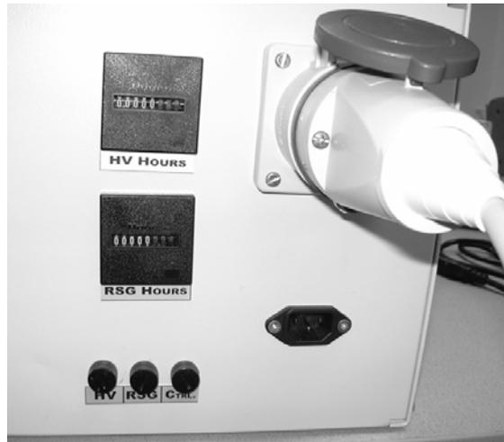
Abb. 6-2: Rückansicht der Ansteuereinheit des Teslatrafos SG-5 („TTr2“)
