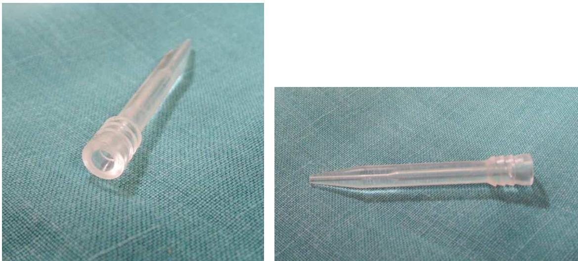
**Abbildung 5.12 TransFix-Schraube, Detailansichten (Originallänge 50 mm)**
