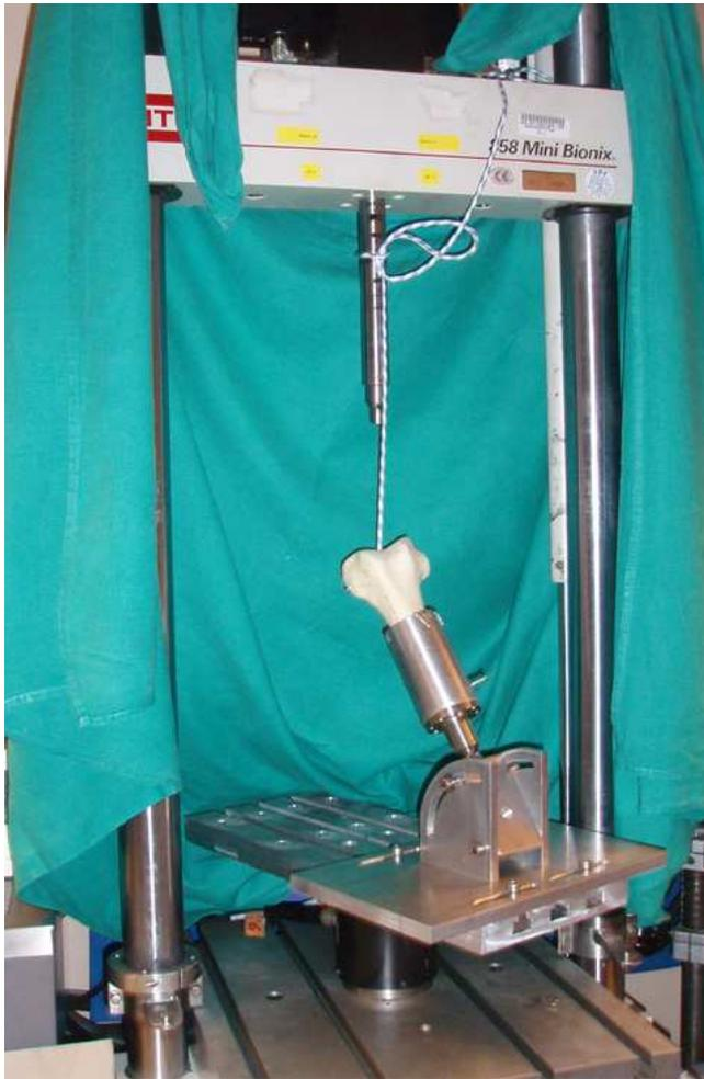
**Abbildung 4.3 Schema Testaufbau - fixierter Kunstknochen mit Kunststoffseil**
