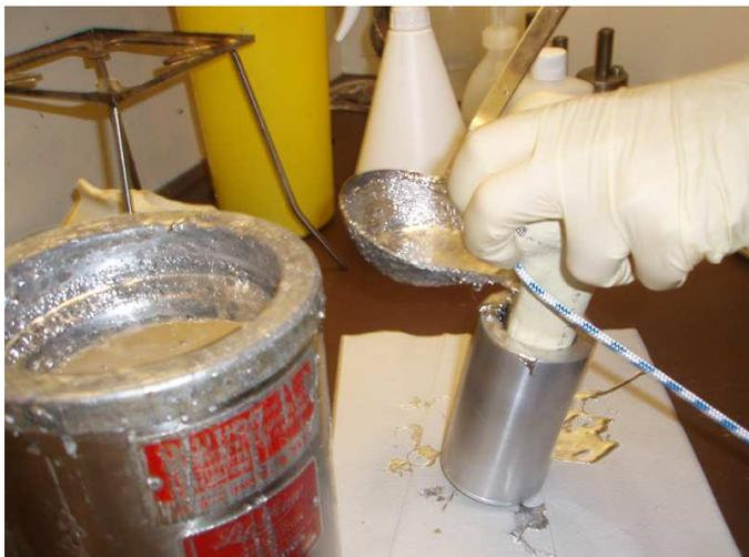
**Abbildung 4.1** Eingießen des saw-bone in den Metallzylinder
