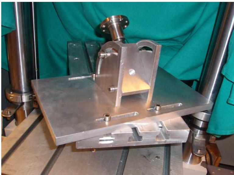
**Abbildung 4.8 Halterung für eingegossenen Femurknochen**
