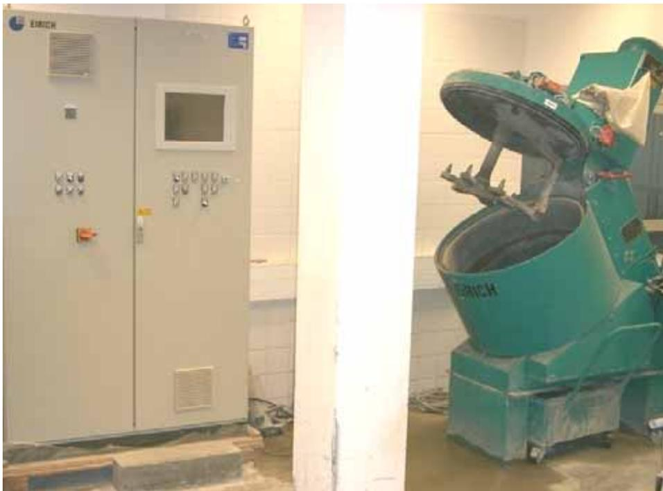
Abbildung 4-10: *Eirich-Intensivmischer* mit Schaltkasten
