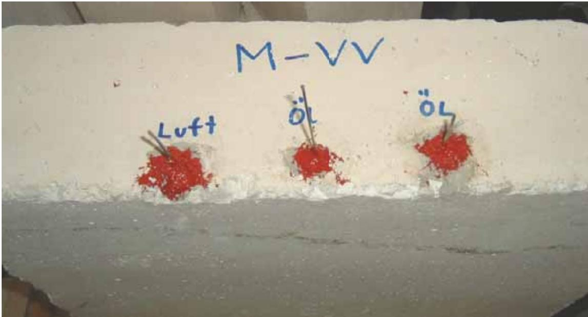
Abbildung 5-25: Platte M-Versuch 4 nach Aufbringen der Dichtungsmasse
