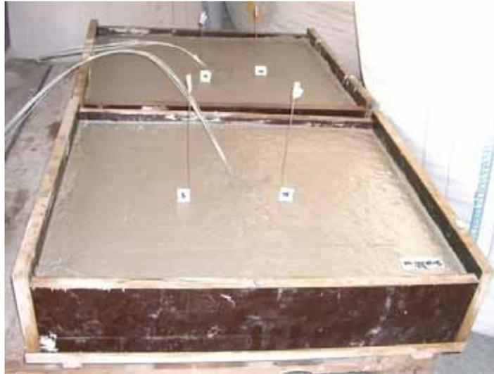
Abbildung 5-3: Kapillarrohre in Frischbeton
