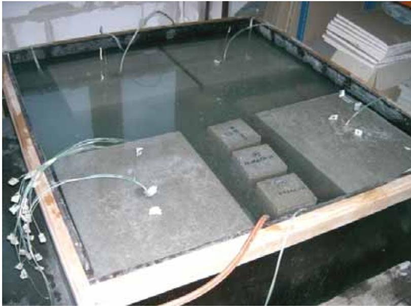
Abbildung 4-16: Wasserlagerung
