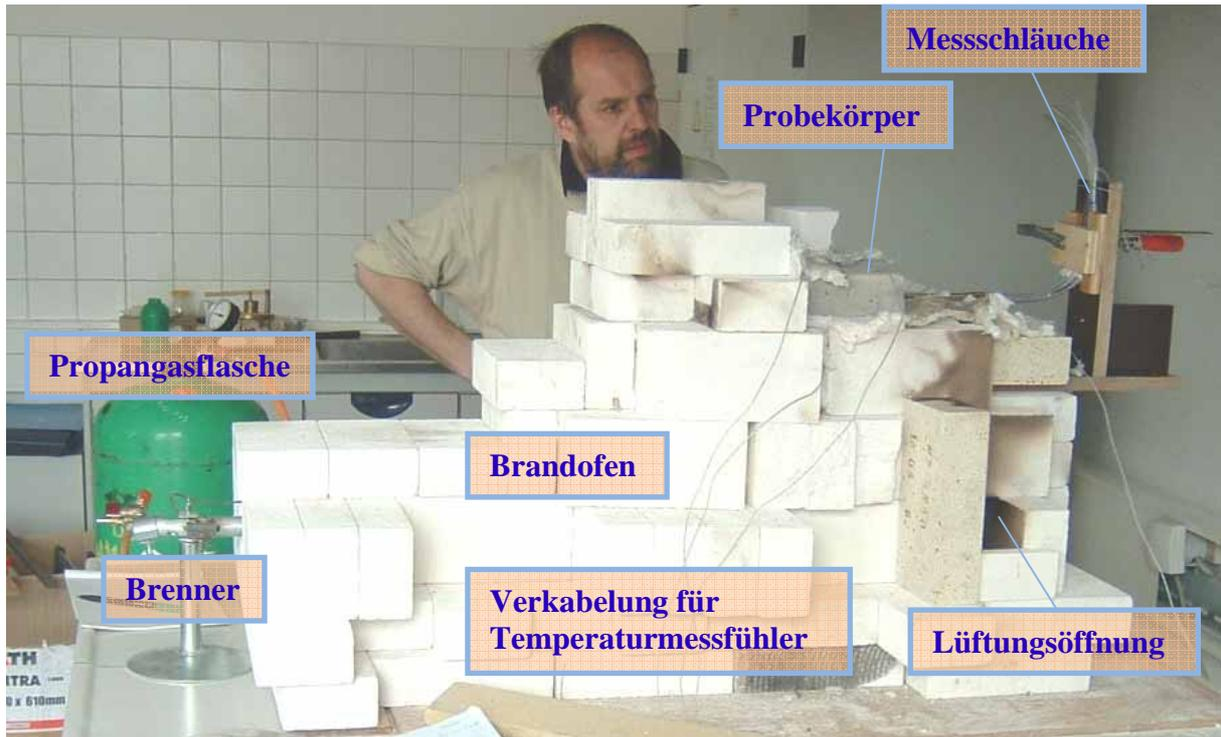
Abbildung 5-31: Prüfanordnung Versuch 5
