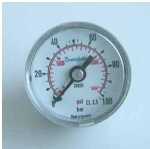
Abbildung 5-6: Manometer bis 100 bar
