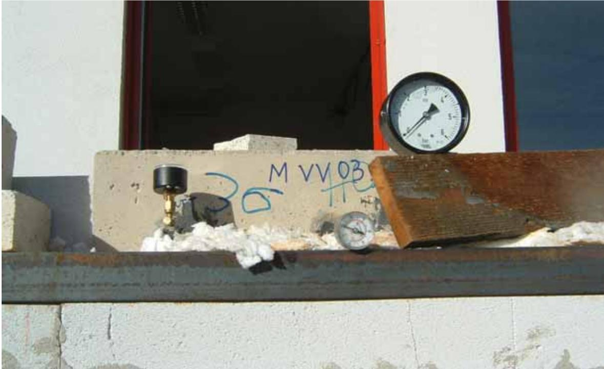
Abbildung 5-20: Anordnung Manometer Versuch 4
