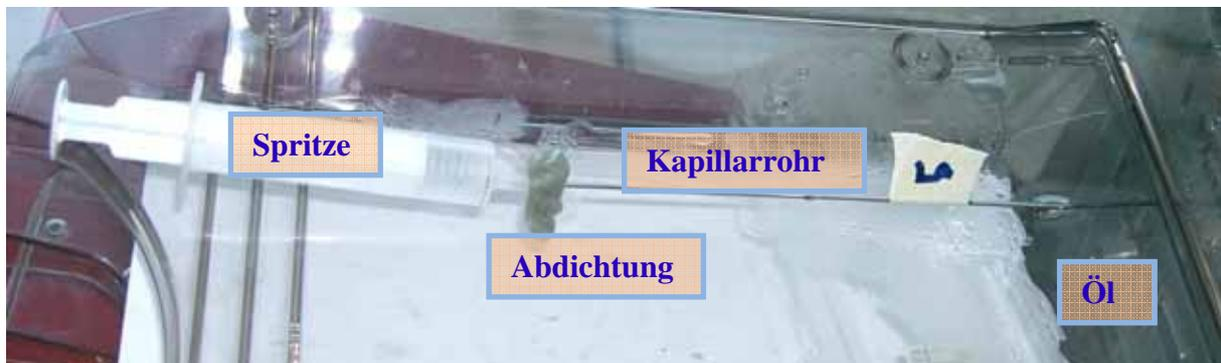
Abbildung 5-4: Füllen der Kapillarrohre
