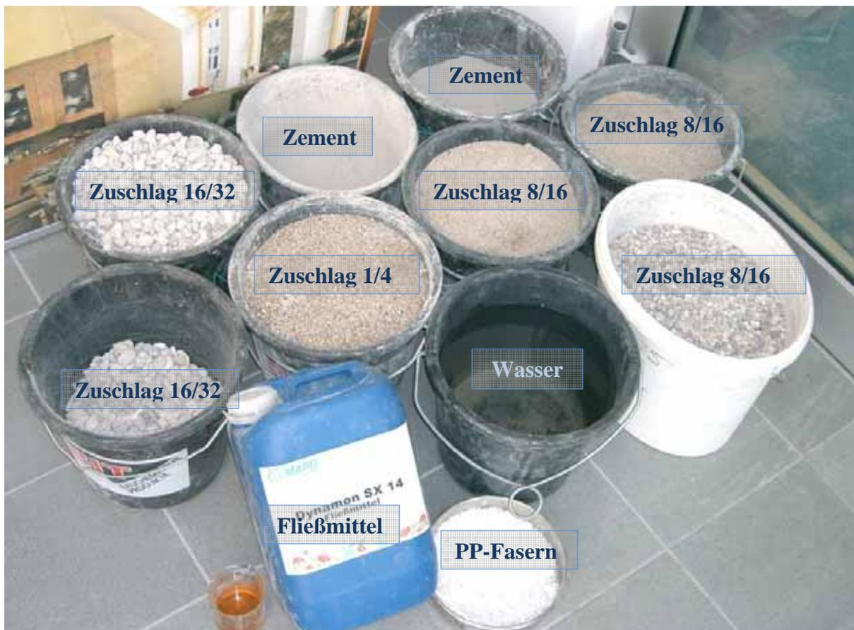
Abbildung 4-9: Betonbestandteile Mischung RK 02
