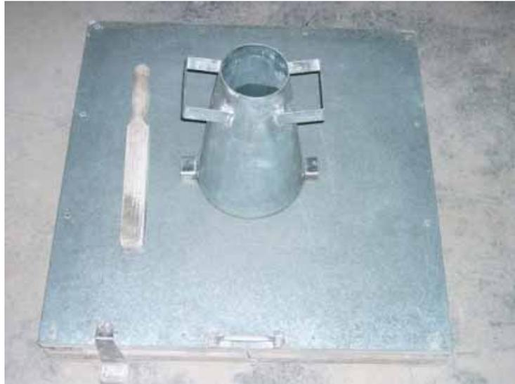
Abbildung 4-17: Ausbreittisch mit Stößel und Prüfform
