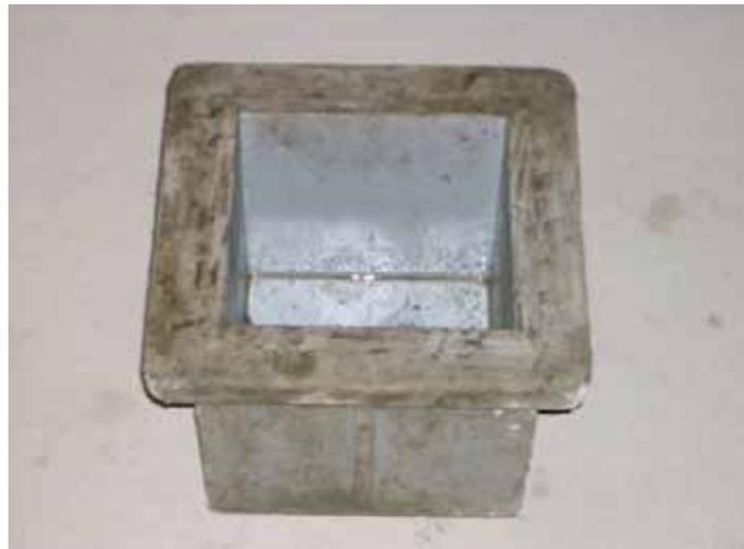
Abbildung 4-15: Schalung Probewürfel
