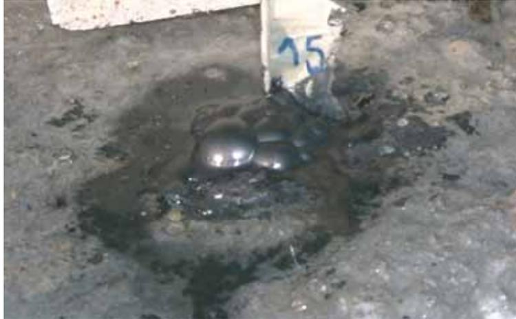
Abbildung 5-12: Blasenbildung bei der Dichtmasse an Platte M-HV10-1 RK 02
