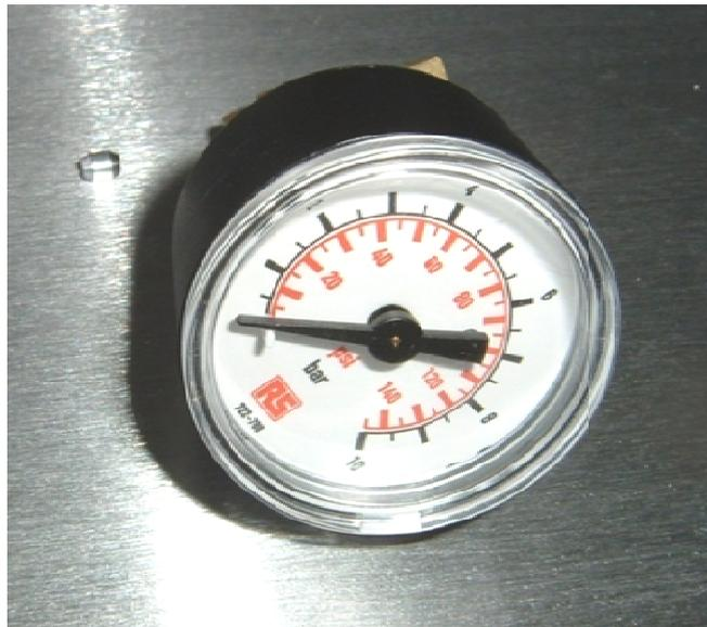
Abbildung 5-18: Manometer, Messbereich 0-10 bar
