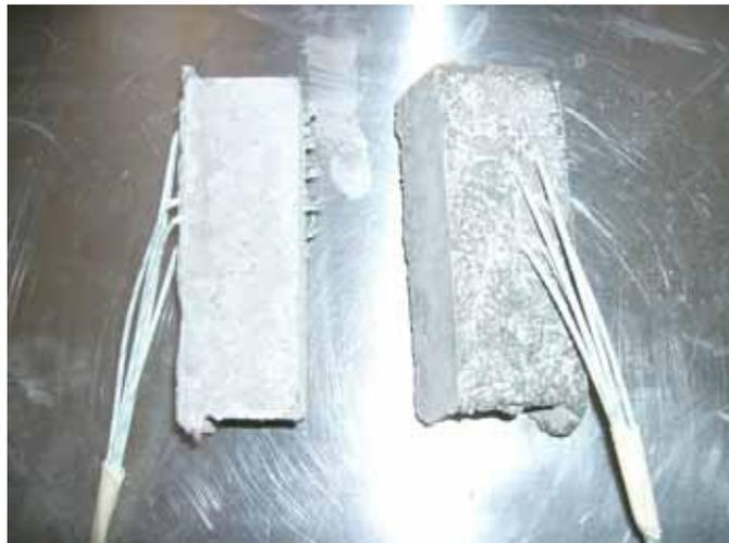
Abbildung 4-14: Thermoelemente
