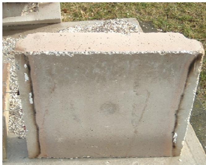
Abbildung 5-28: Platte M -VV-04 nach dem Brandversuch
