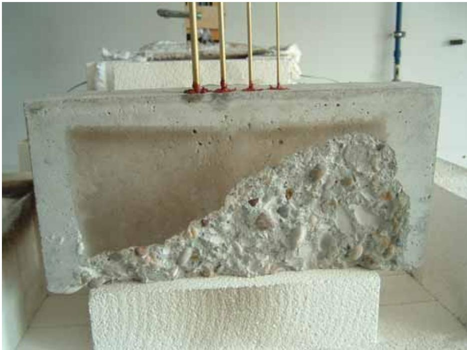
Abbildung 5-35: Abplatzungen Versuch 5
