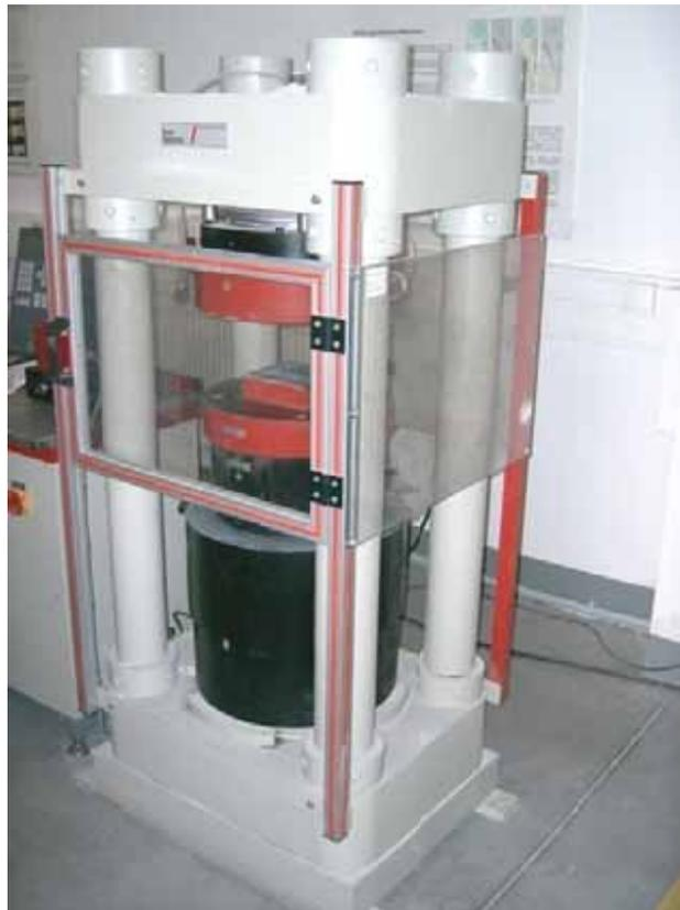
Abbildung 4-19: Prüfmaschine Druckfestigkeit
