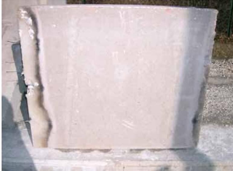
Abbildung 5-23: Platte M-VV-03 nach dem Brandversuch
