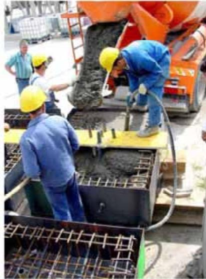
Abbildung 3-11: Versuchskörper mit Druckmessenden (W. Lindlbauer et al. S.3 [32])
