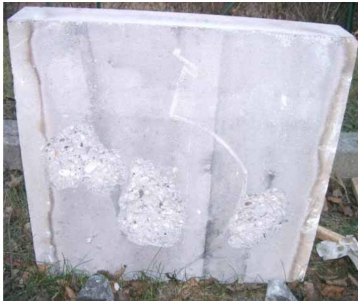
Abbildung 5-13: Platte M-HV10-1 RK 02 nach Brandversuch
