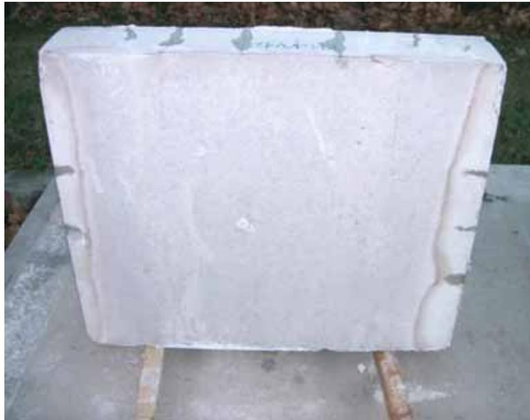
Abbildung 5-2: Platte KM VV 12-2 RK 01 nach dem Brandversuch
