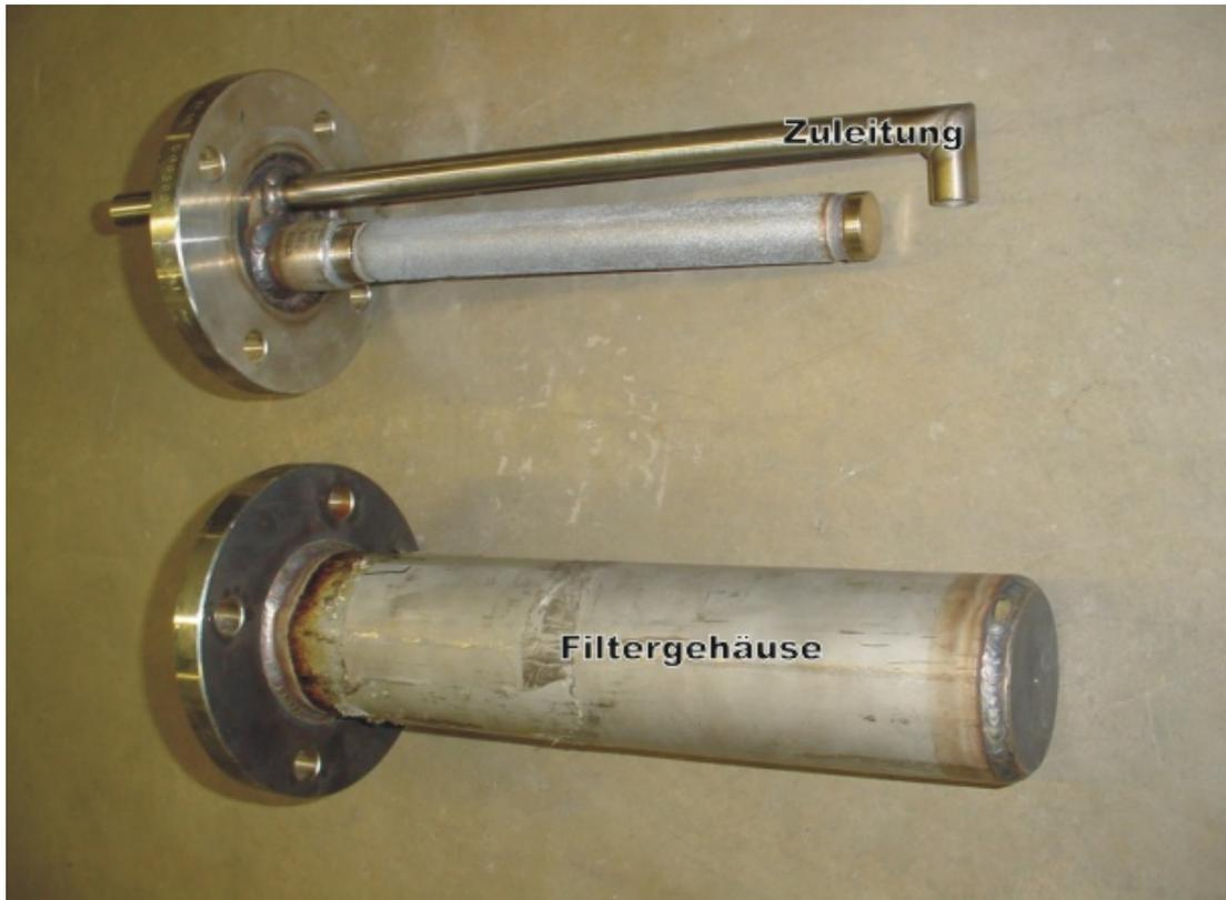
Abbildung 3-12: HTMF mit Filtergehäuse
