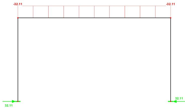
Abbildung 4.12: Brücke einfeldrig – Normalkräfte aus Belastung und Temperaturbeanspruchung
