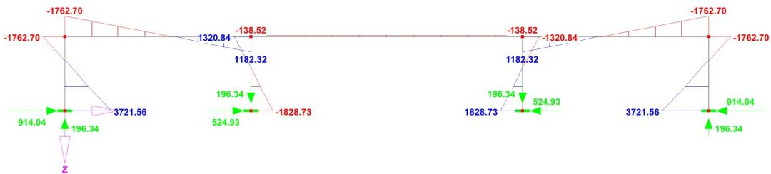
Abbildung 4.25: Momente und Auflagerkräfte aus Temperaturbeanspruchung
