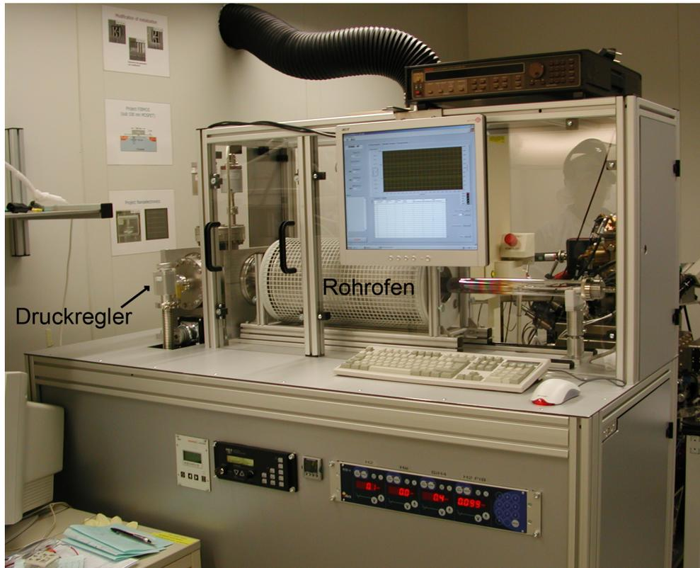
Abbildung 12: Aufbau der LP - CVD Anlage
