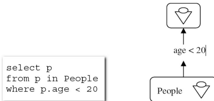
**Abbildung 4.12:** Ein einfacher Vergleich mit dazugehörigem OQL-Code (aus [Murray2000]).
