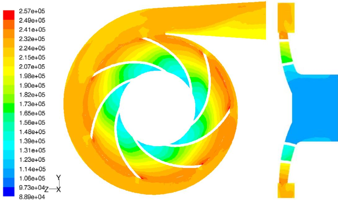
**Abbildung 9-9 Totaldruckverteilung des ursprünglichen Simulationsmodells – Kap.9.3.3 - Seitenschnitt und Meridianschnitt**
