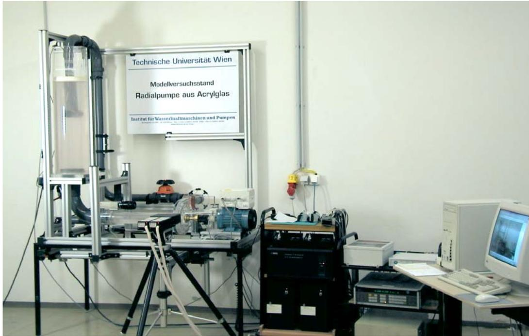
**Abbildung 5-1 Pumpenprüfstand**
