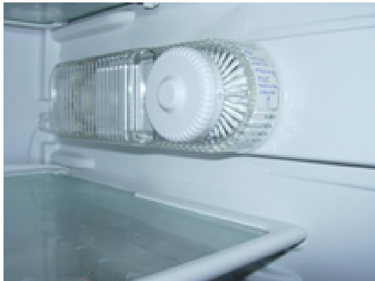
Abbildung 2.6: Thermostat eines Kühlschranks. Quelle: Author
