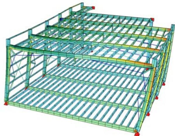
*Dynamische Belastung (Erdbeben, erste Eigenform): horizontale Verschiebung der Struktur, Seilverspannungen werden aktiviert.*
