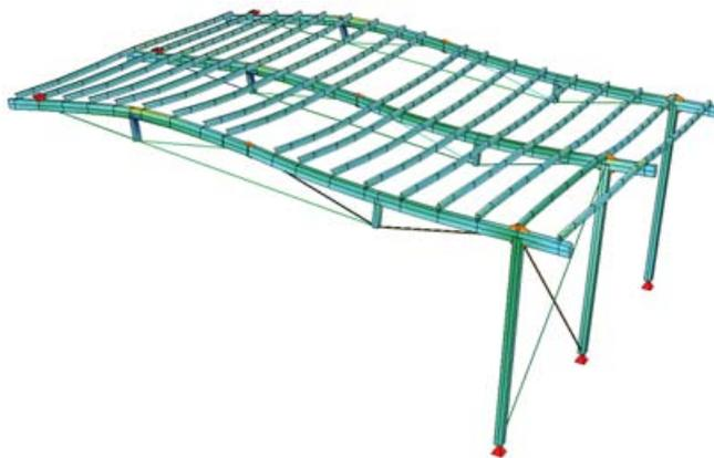
*Verformung und Spannungen unter Eigengewicht*
