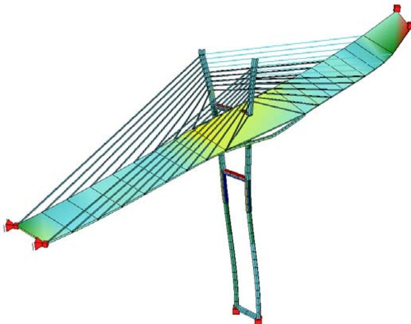
*Verformung und Spannungen unter Eigengewicht*
