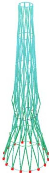
*Verformung und Spannungen unter Eigengewicht*
