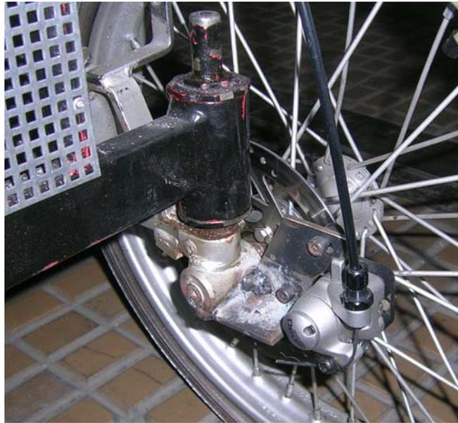
Abbildung 3.8: Foto der Vorderbremse
