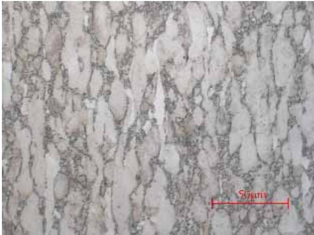
(a) Ti64 Ingot: Lieferzustand, geätzt
