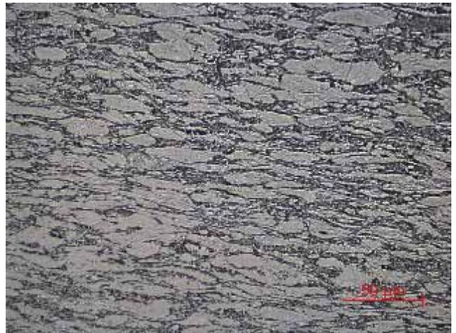
(d) Ti64 Ingot:  $\epsilon=22\%$ , 350°C, geätzt
