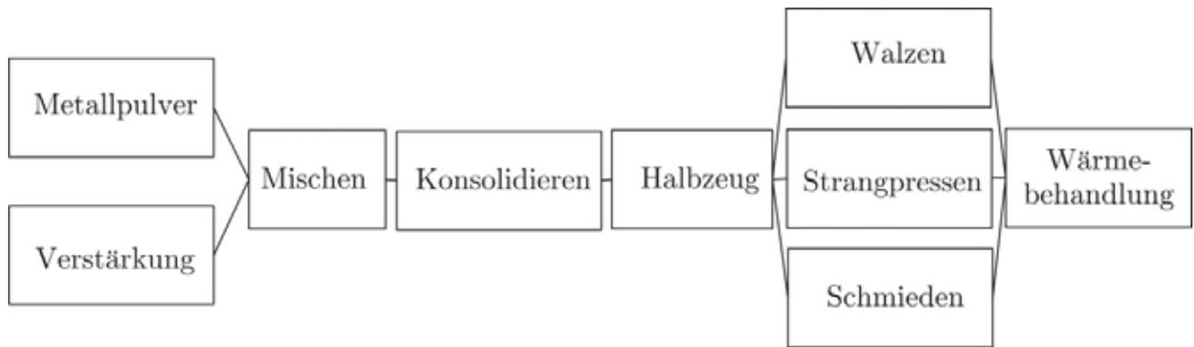
Abbildung 2.4 Prozessablauf bei der Herstellung von PM-MMCs [4]
