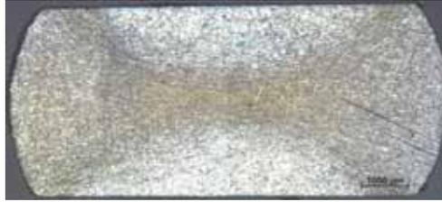
Abbildung 4.7 Verformungszonen an einer Ti Grade2 Stauchprobe
