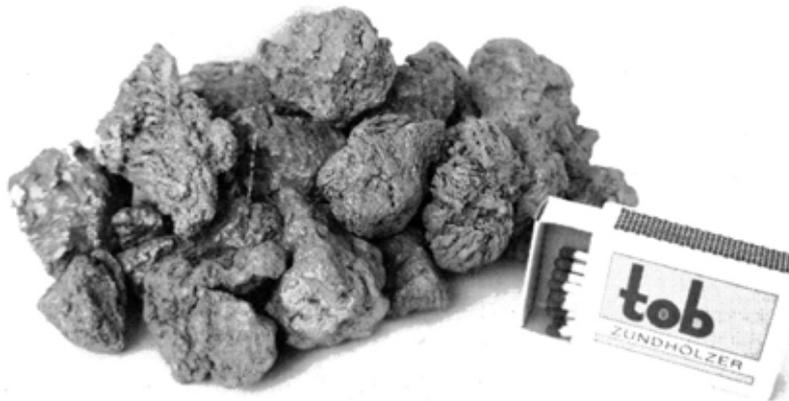
Abbildung 2.2 Titanschwamm [2]
