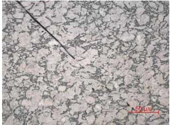
(b) Ti64 Ingot:  $\epsilon=41\%$ , Raumtemperatur, geätzt mit Riss
