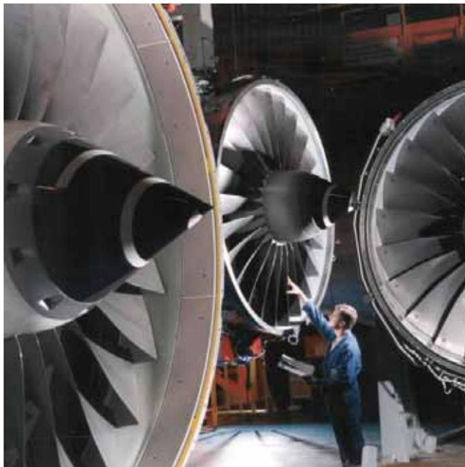
Abbildung 1.3 Fan-Stufen eines *Rolls-Royce Trent* Triebwerkes aus Ti-6Al-4V [15]
