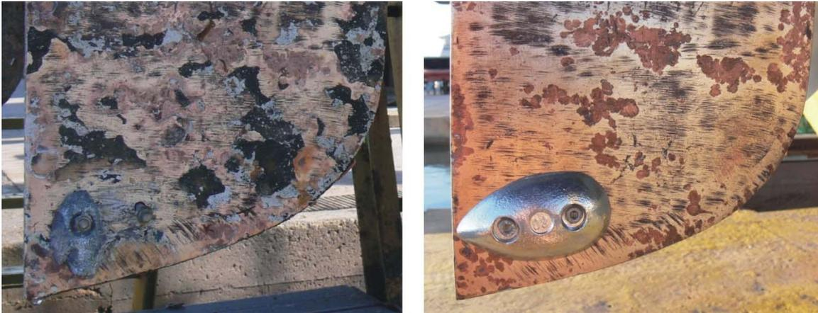
Abb. 5.4: Steuerbordruder; links: die Zinkopferanode ist völlig zerstört, Rückstände hängen lose an der Befestigungsschraube und bieten keinen Schutz vor galvanischer Korrosion; rechts: neu applizierte Anode mit leitendem Kontakt zum zu schützenden Grundmaterial, die rötlichen Flecken sind mit bloßem Auge auf der goldgelben Oberfläche der Kupfer-Zink-Legierung erkennbar, und deuten auf eine bereits weit fortgeschrittenen Entzinkung des Bauteils hin (Fotos: Punat im Juni 2007)
