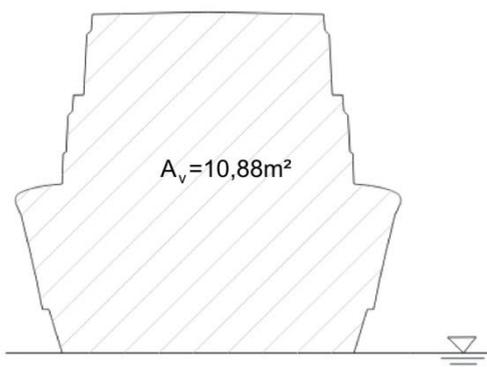
Abb. 3.12: Frontalquerschnitt Überwasserschiff inkl. Aufbauten (CAD-Daten aus FREE!ship)
