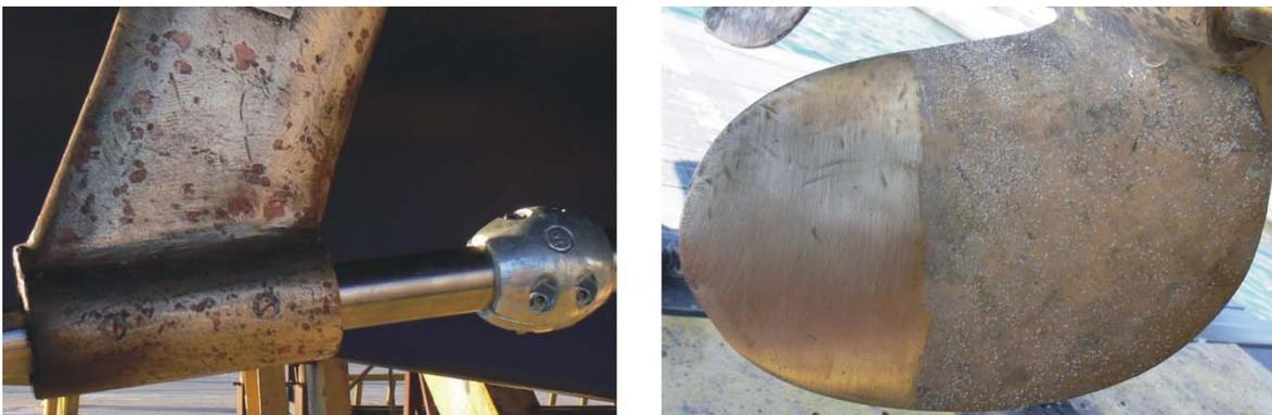
Abb. 5.5: links: gereinigter Steuerbordwellenbockarm mit Welle und neuer Zinkopferanode, rötliche Flecken deuten auf Entzinkung hin; rechts: Propellerflügel bis zur Hälfte von tierischem Bewuchs (vor allem Rohrwürmern) gereinigt, keine erkennbaren Anzeichen von Korrosion, lediglich Kratzer durch schlechte Wartung (Fotos: Punat im Juni 2007)
