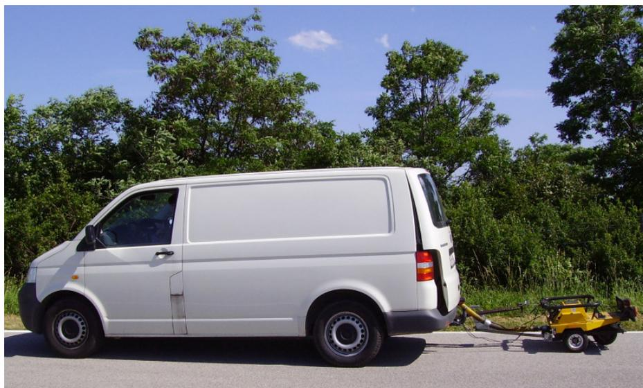
Abbildung 5-11: GripTester im Schleppbetrieb (Foto: Achleitner).
