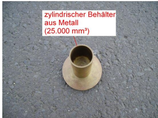
Abbildung 5-6: Probenbehälter inklusive Verteilerwerkzeug von oben (Foto: Achleitner).
