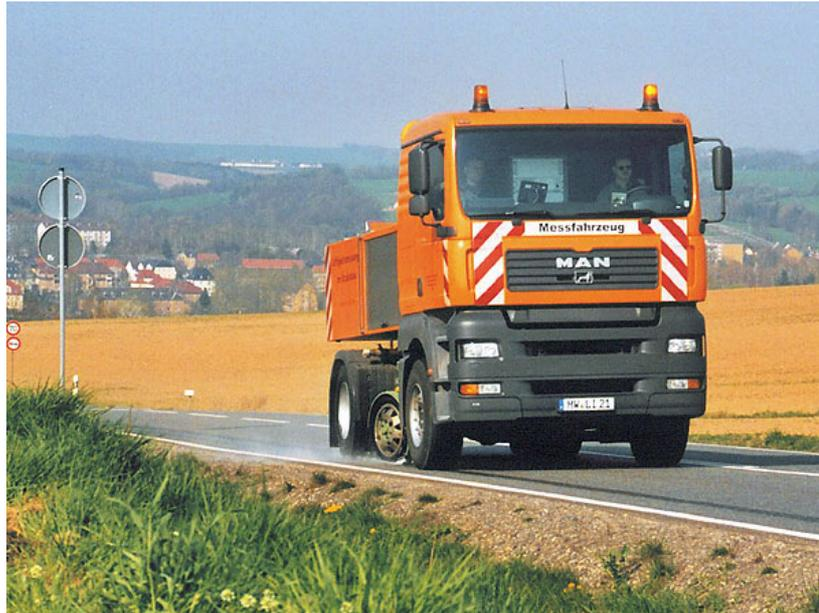
Abbildung 5-30: Messfahrzeug SCRIM im Messeinsatz [LSt, 2006].
