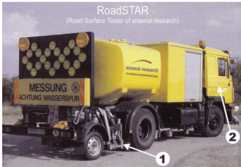
Abbildung 5-44: Messfahrzeug RoadSTAR I (1 – Lasertexturmesseinrichtung, 2 – digitale Messwerterfassung) [MAURER et al., 2002].
