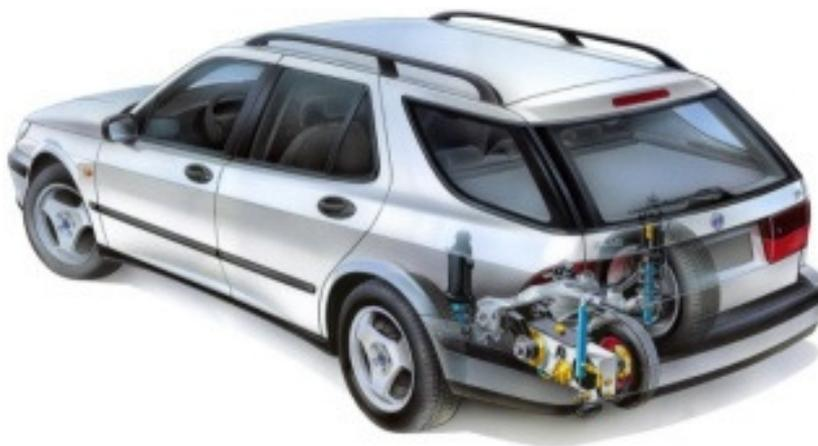
Abbildung 5-38: SARSYS Friction Tester (SFT) [SARSYS, 2007].
