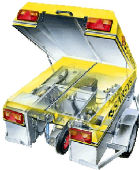
Abbildung 5-39: SARSYS Trailer Friction Tester (STFT) [SARSYS, 2007].
