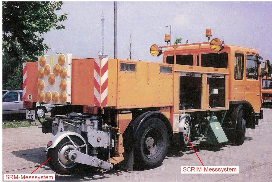
Abbildung 5-23: Das SRM-/SCRIM-Messsystem des BAST-Messfahrzeuges [HUSCHEK et al., 1996a].
