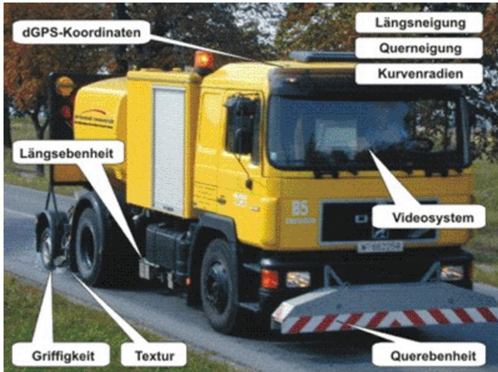
Abbildung 5-16: Messfahrzeug RoadSTAR I im Messeinsatz [ARSENAL, 2006].
