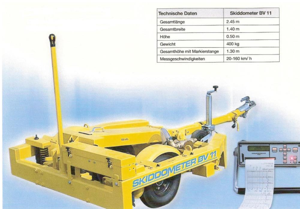
Abbildung 5-26: Skiddometer BV 11 mit tragbarem Computer MI 90 [WINDHOFF, 2006].
