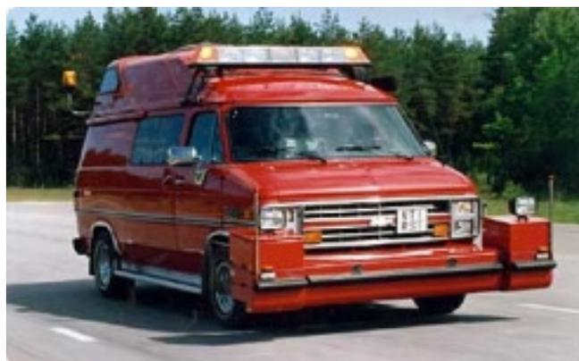
Abbildung 5-48: RST (Road Surface Tester) Forschungsfahrzeug [VTI, 2007].
