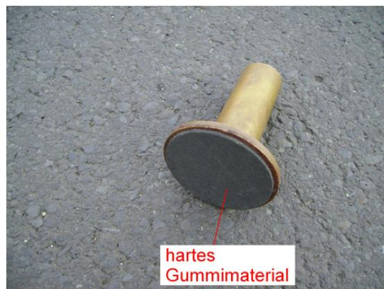
Abbildung 5-7: Unterseite des Probenbehälters und Verteilerwerkzeugs (Foto: Achleitner).
