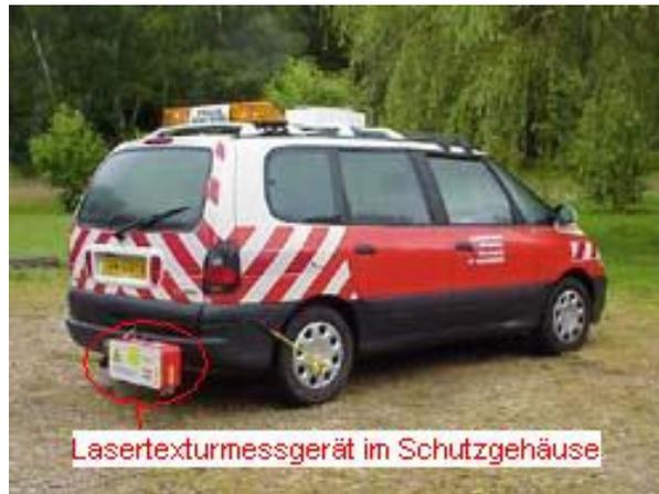
Abbildung 5-47: RUGO - Lasertexturmessgerät [VECTRA, 2007].
