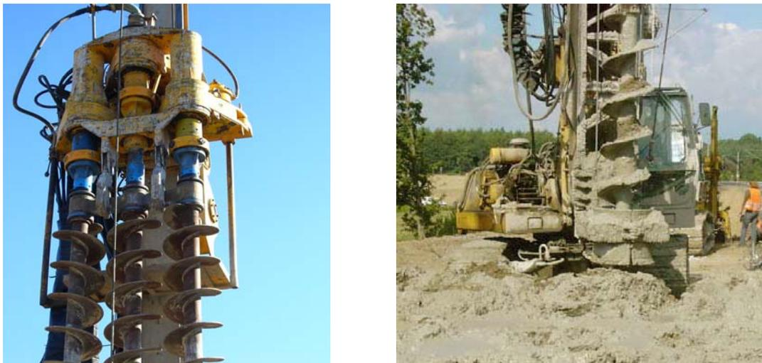
Abbildung 31: MIP Dreifach Endlosschnecke (*links*); MIP Einfachschnecke (*rechts*) [31]
