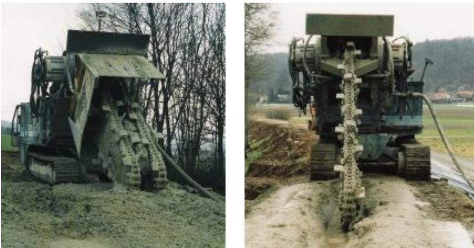
Abbildung 58: Fräsbaum mit einer Breite von 1,0 m (*links*) bzw. 0,35 m (*rechts*) [39]
