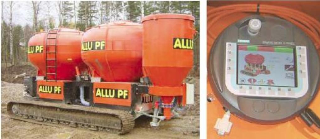
Abbildung 65: Mobile Vorratsilos PF 7+7 (*links*) und digitaler Messschreiber zur Qualitätssicherung (*rechts*) [40]
