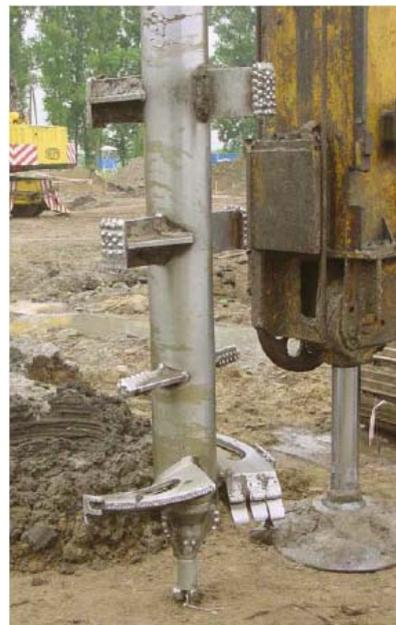
Abbildung 9: Dreifachschnecke *links*; Bohrstange mit Mischpaddel [24] *rechts*
