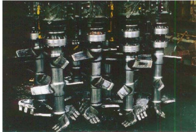
Abbildung 10: DM-Maschine mit vier Mischwellen (*links*) [24]; DM-Maschine für maritime Arbeiten mit acht Mischwellen (*rechts*) [24]
