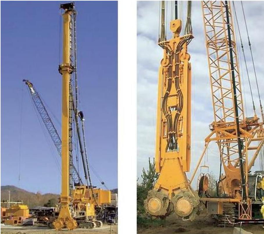
Abbildung 54: "stangengeführte"- (links) und "seilgeführte"- (rechts) -CSM-Einheit [19]
