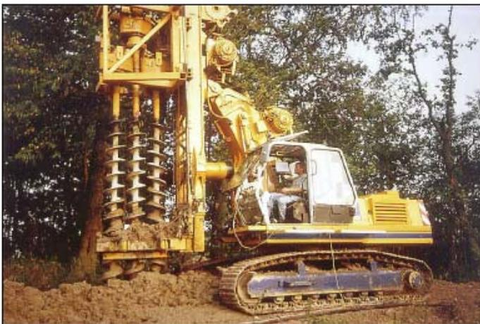
Abbildung 18: MIP-Dreifachschnelle zum Arbeiten zwischen den Ketten parallel zur Fahrtrichtung [31]
