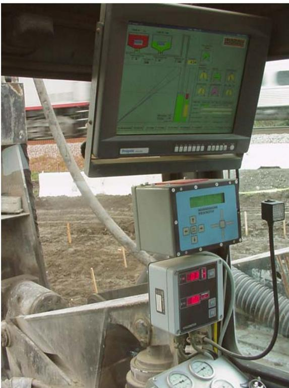
Abbildung 75: Typische Messeinheit am Drehbohrgerät [37]
