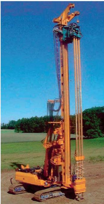
Abbildung 36: SMW Dreifachbohrer mit Mischpaddel [31]
