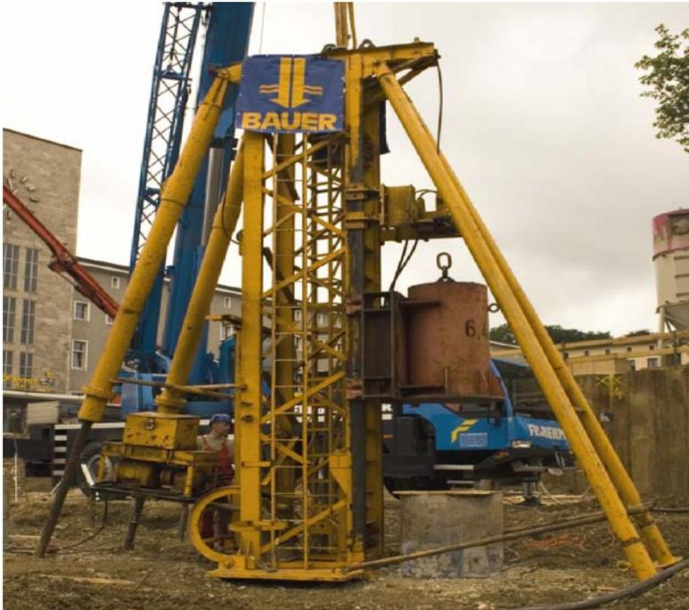
Abbildung 77: Aufbau dynamische Pfahlprüfung mit Fallgewicht [44]
