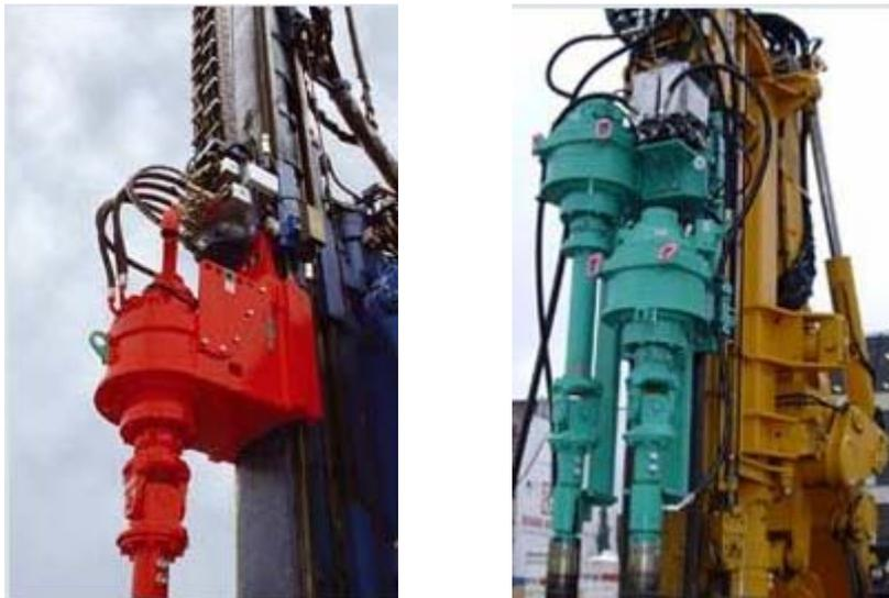
Abbildung 40: Bohrantriebe MDBA (links), TMBA (rechts) [59]
