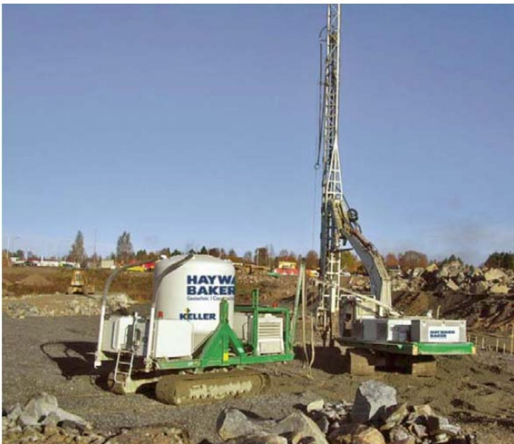
Abbildung 42: Keller Grundbau Trockenmischeinheit [35]
