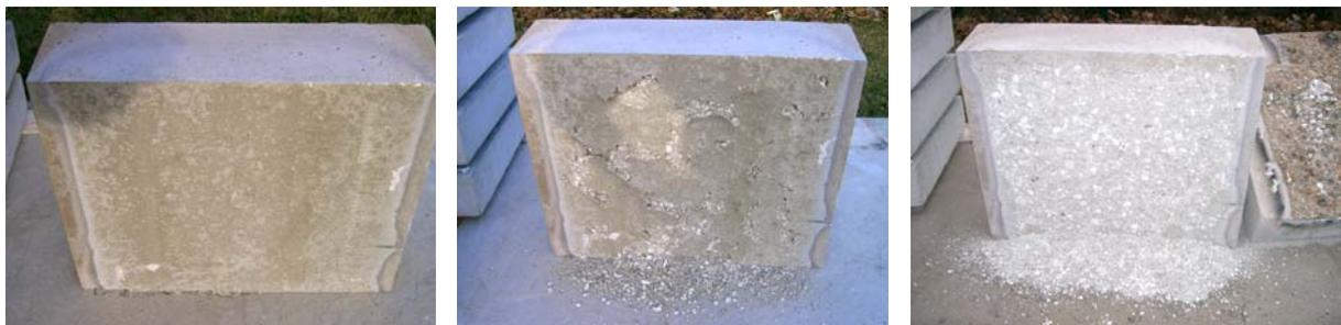
Abbildung 11-4: KM-HV16-1 RK01 (mit PP-Fasern) nach Brandversuch, nach 1 h, nach 1 d
