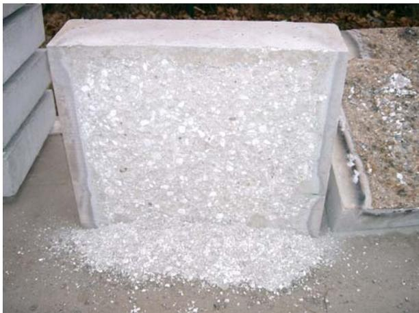
Abbildung 5-22: KM-HV16-1 RK01 (mit 1,5 kg/m<sup>3</sup> PP-Fasern; 1 Tag nach dem Brandversuch)
