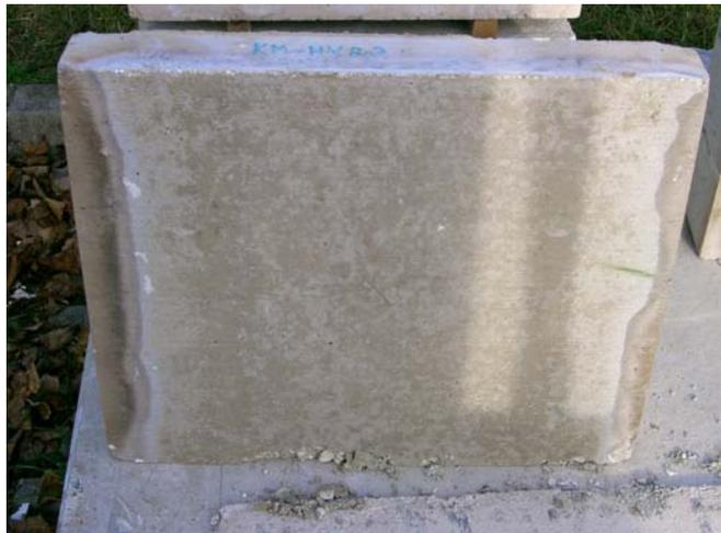
Abbildung 4-9: KM-HV8-3 RK01 nach Brandversuch
