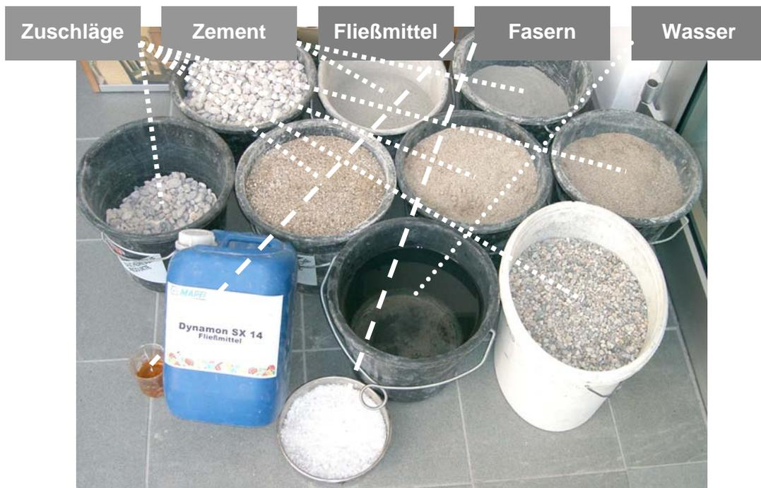
Abbildung 4-2: Betonkomponenten für die Hauptversuche
