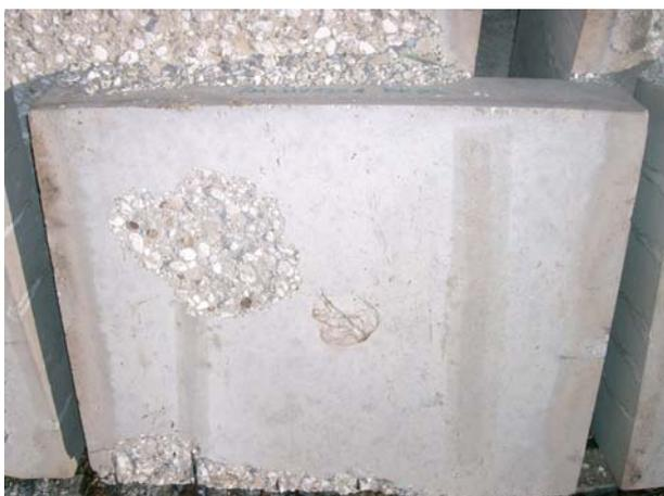
Abbildung 5-24: KM-HV12-1 RK02 (ohne PP-Fasern; 1 Tag nach dem Brandversuch)
