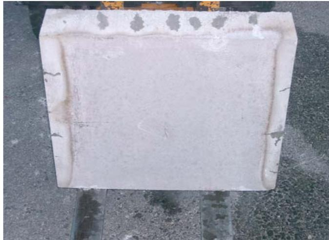
Abbildung 3-11: KM-VV12-1 RK01 nach Brandversuch
