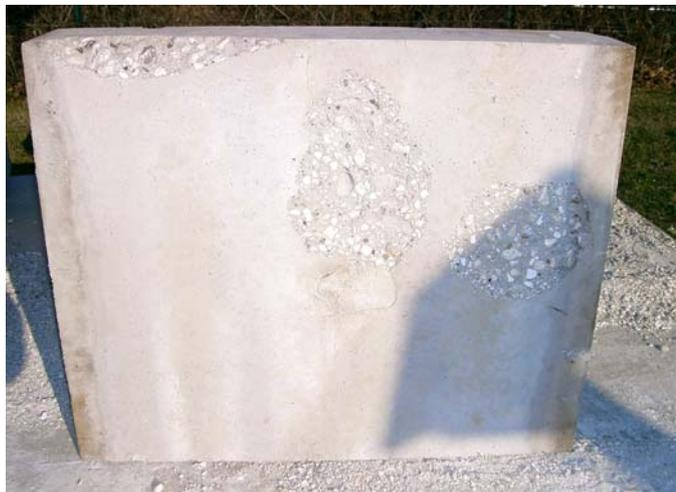
Abbildung 4-21: KM-HV12-3 RK02 nach Brandversuch
