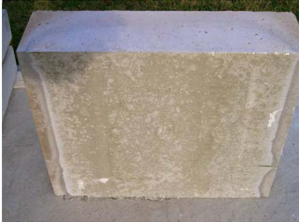
Abbildung 5-20: KM-HV16-1 RK01 (mit 1,5 kg/m<sup>3</sup> PP-Fasern; 2 Minuten nach dem Brandversuch)
