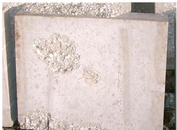
Abbildung 5-25: KM-HV12-1 RK02 (ohne PP-Fasern; 3 Tage nach dem Brandversuch)
