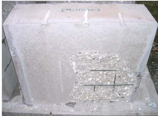
Abbildung 4-16: KM-HV20-3 RK01 nach Brandversuch
