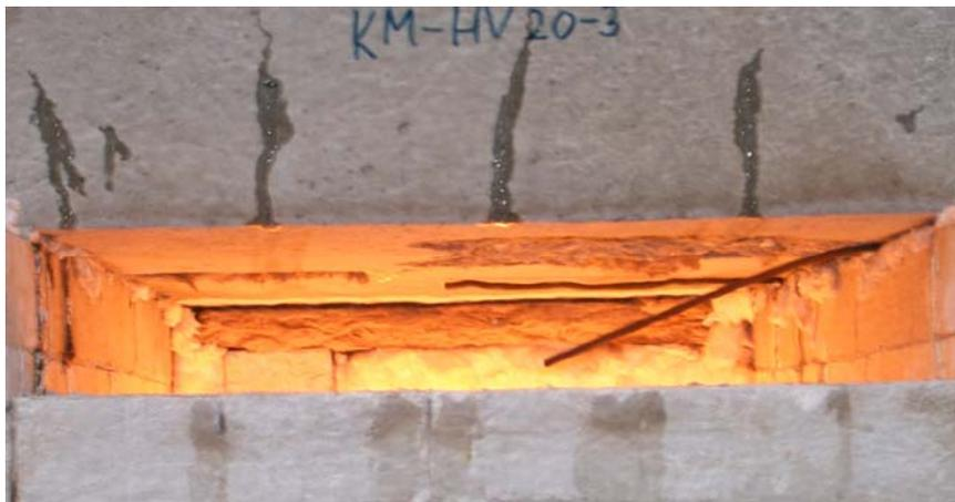
Abbildung 5-13: Abplatzungen KM-HV20-3 RK01 (während Brandversuch 6)
