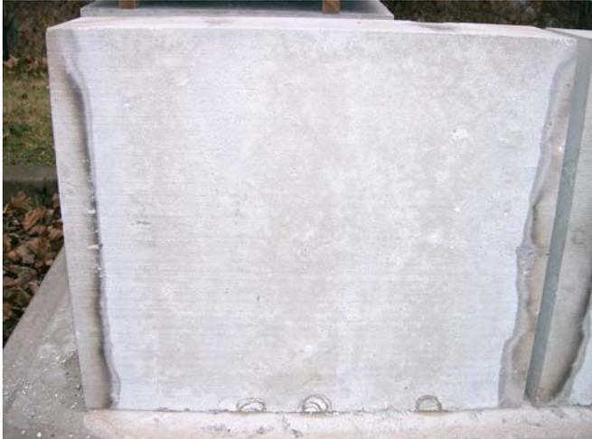
Abbildung 4-12: KM-HV16-3 RK01 nach Brandversuch
