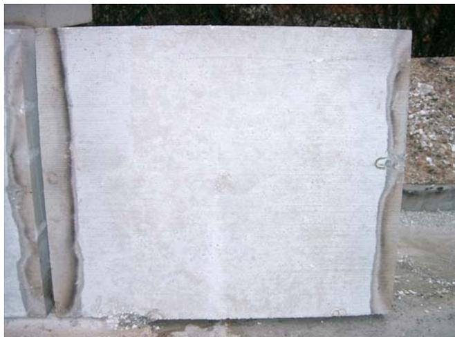
Abbildung 4-11: KM-HV16-2 RK01 nach Brandversuch
