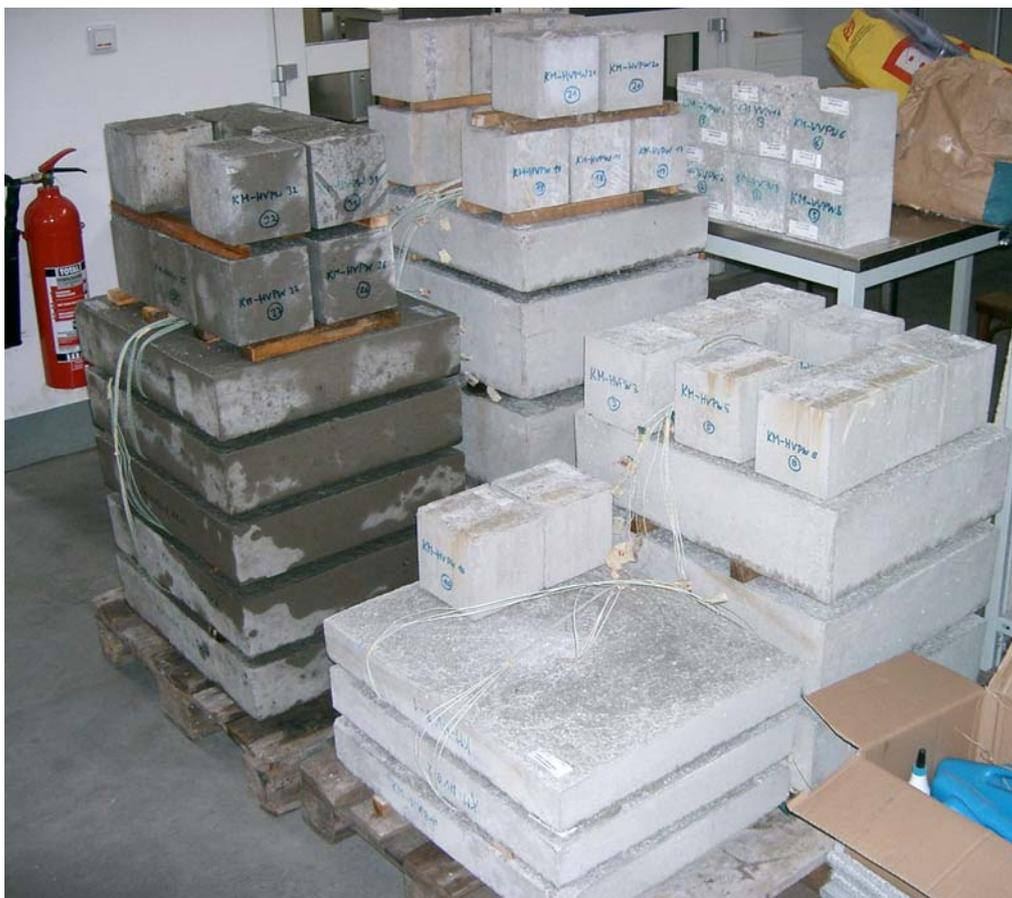
Abbildung 3-8: Luftlagerung der Probekörper (nach der Entnahme aus dem Wasserbad)
