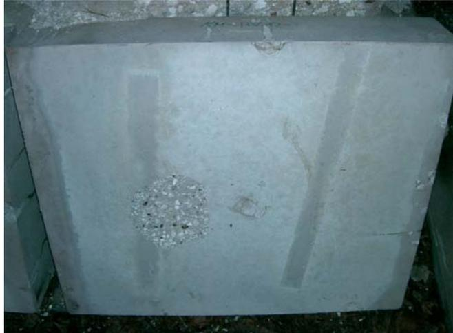
Abbildung 4-20: KM-HV12-2 RK02 nach Brandversuch
