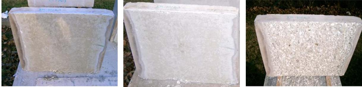
Abbildung 11-3: KM-HV8-3 RK01(mit PP-Fasern) nach 1 h, nach 1 d, nach 3 d
