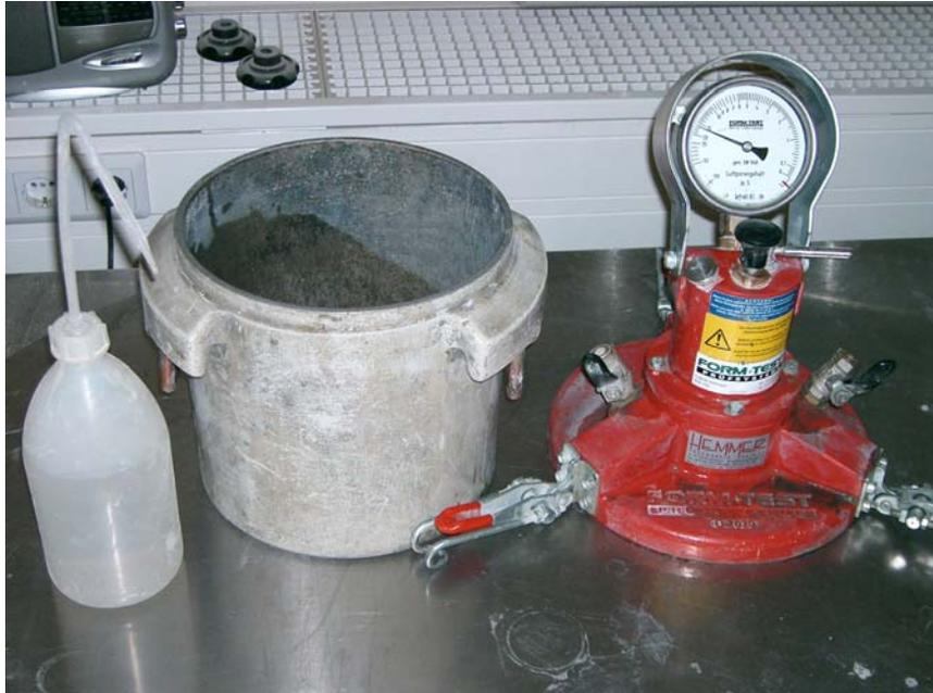
Abbildung 2-2: Luftporenmessapparatur
