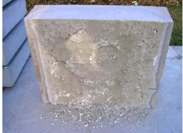
Abbildung 5-21: KM-HV16-1 RK01 (mit 1,5 kg/m<sup>3</sup> PP-Fasern; 1 Stunde nach dem Brandversuch)
