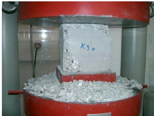
Abbildung 2-4: Druckfestigkeitsbestimmung
