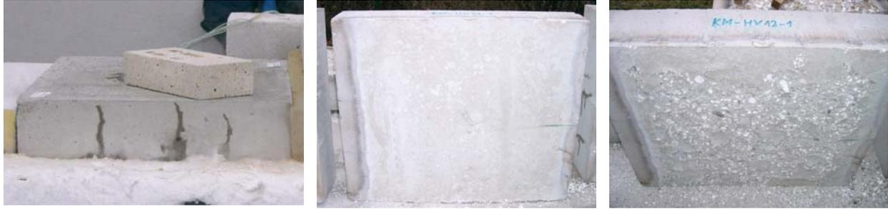
Abbildung 11-7: KM-HV12-1 RK01 (mit PP-Fasern) während Brandversuch, nach Brandversuch, nach 2 h
