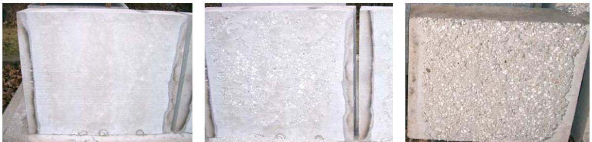
Abbildung 11-6: KM-HV16-3 RK01 (mit PP-Fasern) nach Brandversuch, nach 2 h, nach 3 d
