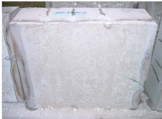
Abbildung 4-15: KM-HV20-2 RK01 nach Brandversuch
