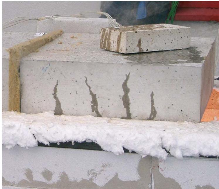
Abbildung 5-9: Wasseraustritt KM-HV16-3 RK01
