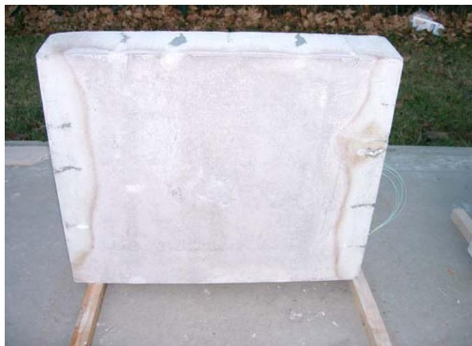
Abbildung 3-12: KM-VV12-3 RK01 nach Brandversuch
