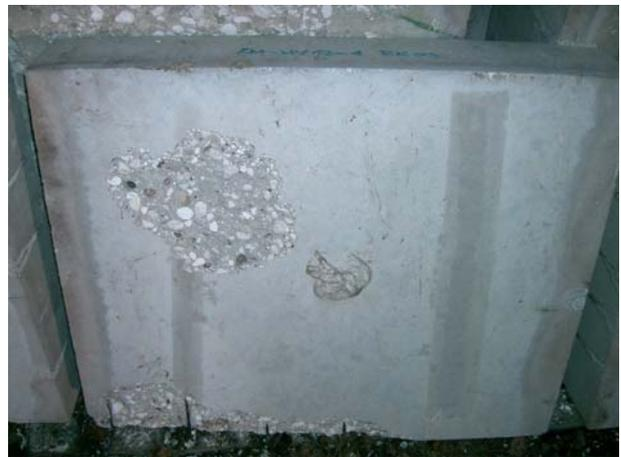
Abbildung 5-23: KM-HV12-1 RK02 (ohne PP-Fasern; 2 Minuten nach dem Brandversuch)
