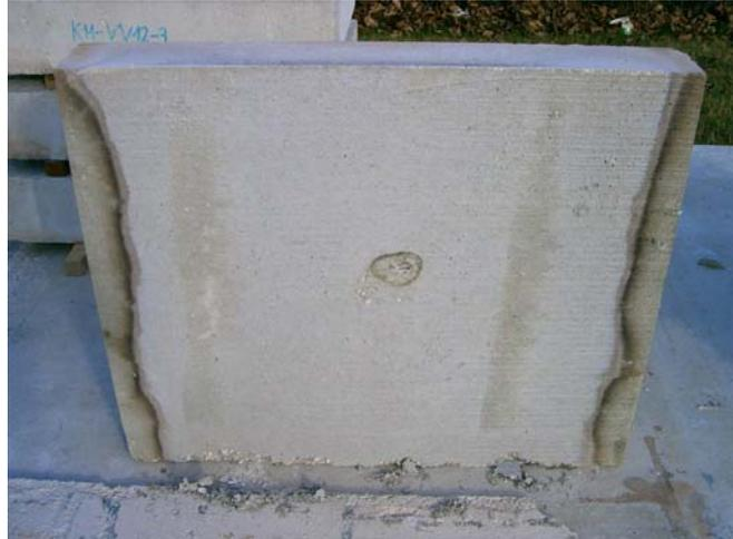
Abbildung 4-8: KM-HV8-2 RK01 nach Brandversuch
