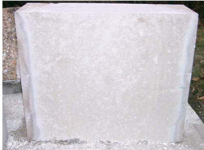
Abbildung 4-14: KM-HV20-1 RK01 nach Brandversuch
