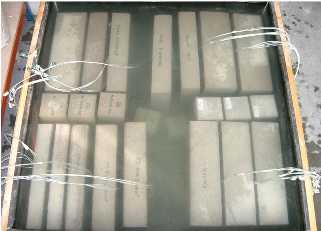
Abbildung 2-3: Wasserlagerung der Prüfkörper
