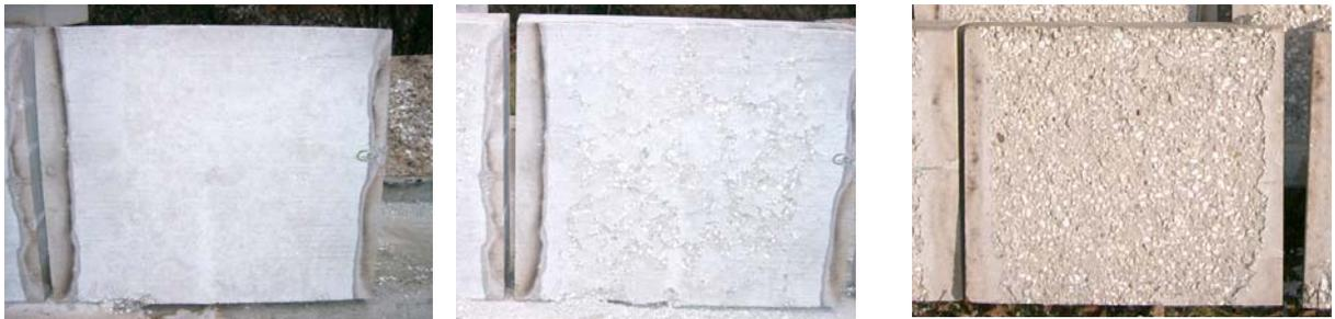
Abbildung 11-5: KM-HV16-2 RK01 (mit PP-Fasern) nach Brandversuch, nach 2 h, nach 3 d
