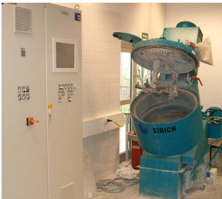
Abbildung 3-4: Wirbelmischer der Fa. *Eirich* (inkl. Steuerschrank)
