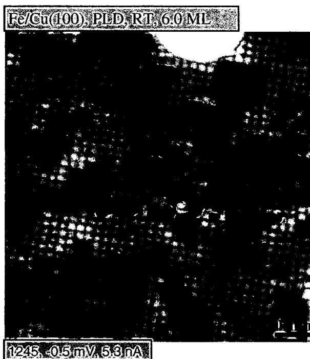
Abb. 4.17: Atomar aufgelöstes STM-Bild der 6. Lage. Während es in den meisten Bereichen nur geringe Abweichungen von einer fcc-Struktur gibt, ist auf Teilen des Films eine  $(2 \times 2) p4g$  Überstruktur feststellbar (siehe Abb. 4.18). Die Natur der dunklen Bereiche ist ungeklärt.
