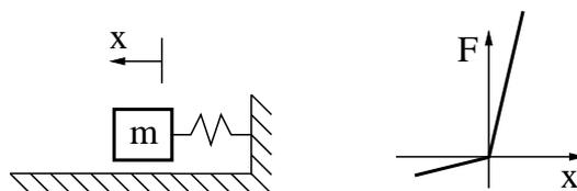
Abbildung 4.6: Einmassenschwinger
