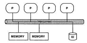
Fig. 3.1. SMP machine model.
