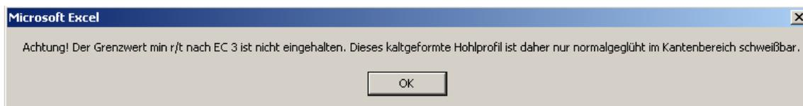
Abbildung 57: Meldung bezüglich der Schweißbeignung bei kaltgefertigten Profilen wenn eine Einschränkung besteht
