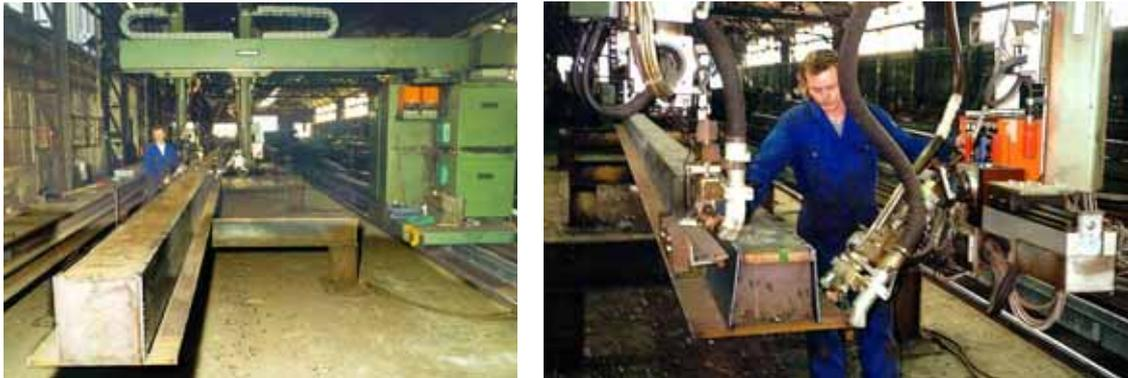
Abbildung 23: Herstellung von Hohlprofilen mit senkrechten und geneigten Stegen [211]
