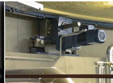
Getriebemotor zum Drehen
