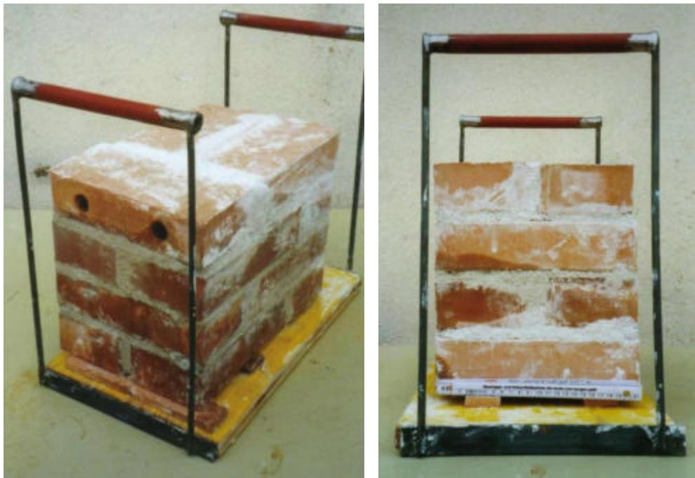
*Abb. 2.36: Aufnahmen der injizierten Wienerberger Mauerwerksprüfkörper*
