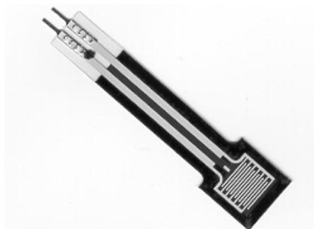
Abb. 4.9: Halbleiter Drucksensor
