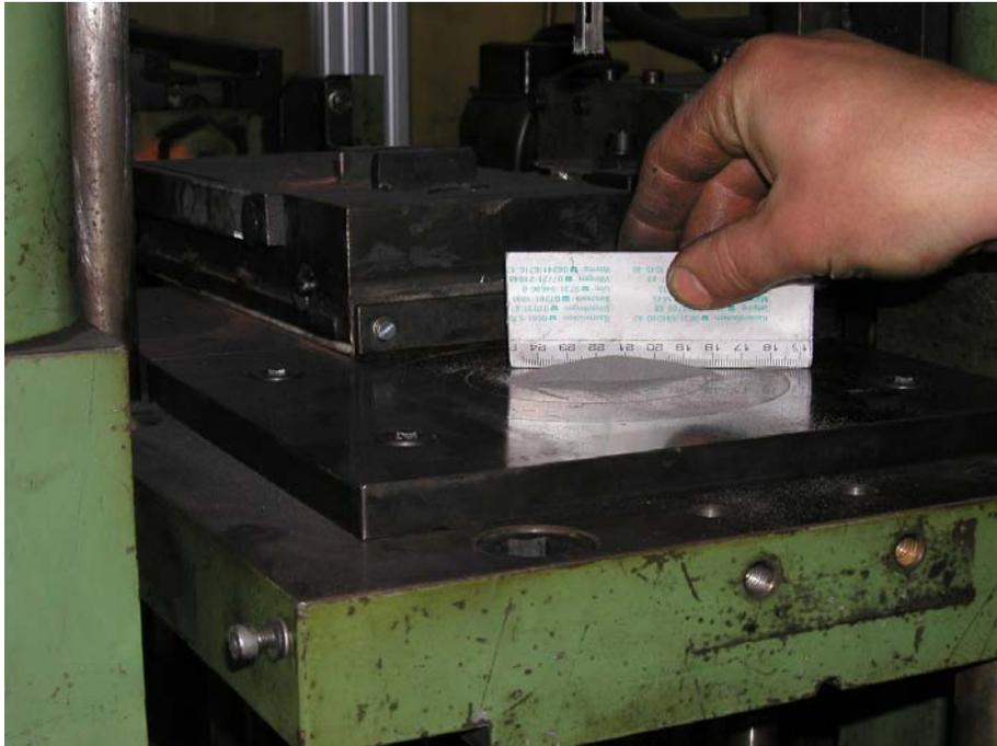
Abb. 6.4: Pulver in die Matrize einformen
