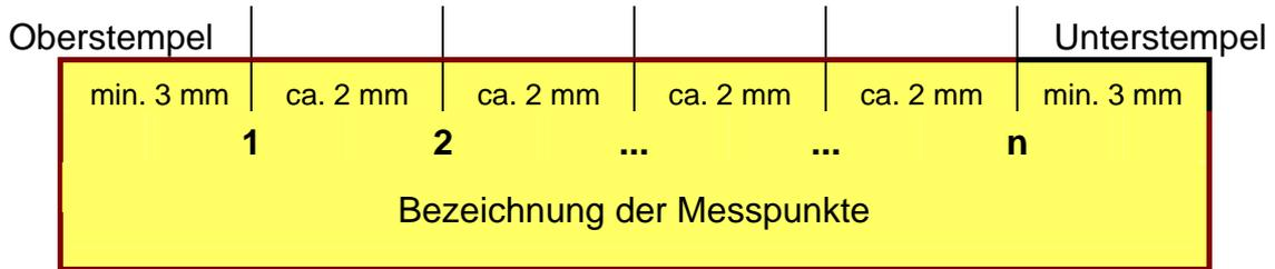
Abb. 6.17: Messpunkt an den Proben (Cu, Cu-Ag)
