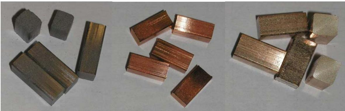
Abb. 6.10: Prüflinge, Verpressung mit 1,4 t. Linkes Teilbild: Eisenpulver (Pulver Nr.1), mittleres Teilbild: Kupferpulver (Pulver Nr. 3), rechtes Teilbild: versilbertes Kupferpulver (Pulver Nr.6)
