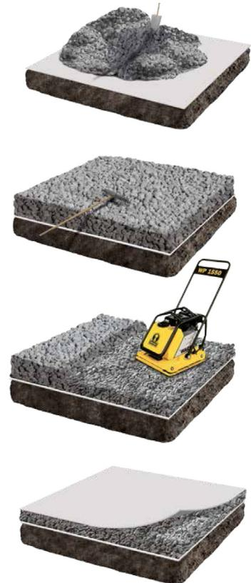
Abb. 2 Ablauf der Einbringung von Glasgranulat
