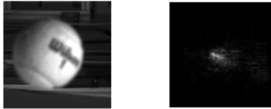
**Abbildung 3.5:** Links das Originalbild, rechts das Bild mit den „Stimmen“ für die möglichen Ballmittelpunkte. Je höher die Intensität vom Pixel, umso wahrscheinlicher ist dieser Pixel der Ballmittelpunkt.
