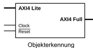
**Abbildung 3.10:** Block des erstellten IP Cores für die Objekterkennung zur Ballmittelpunktbestimmung.
