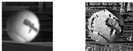
**Abbildung 3.4:** Links das Originalbild, rechts das Bild nach der Anwendung des Mittelwertfilters und der Berechnung der Richtung der Gradientenvektoren.
