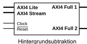
**Abbildung 3.8:** Block des erstellten IP Cores für die Hintergrundsubtraktion.
