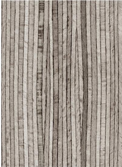
Abb.13 Verbund der Strukturelemente eines Furnierschichtholzträgers, Buche
