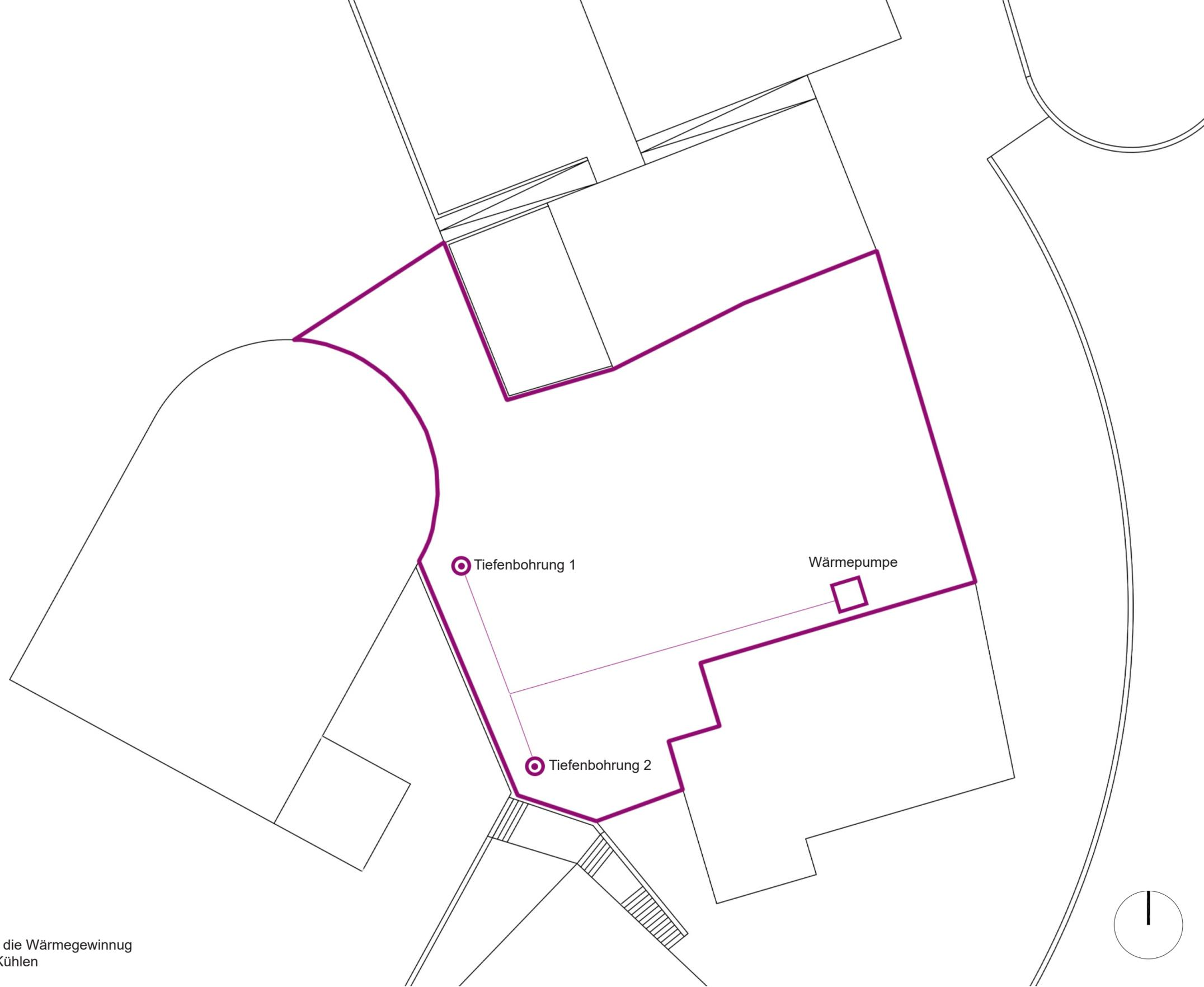
Tiefenbohrung für die Wärmegewinnung zum Heizen und Kühlen
