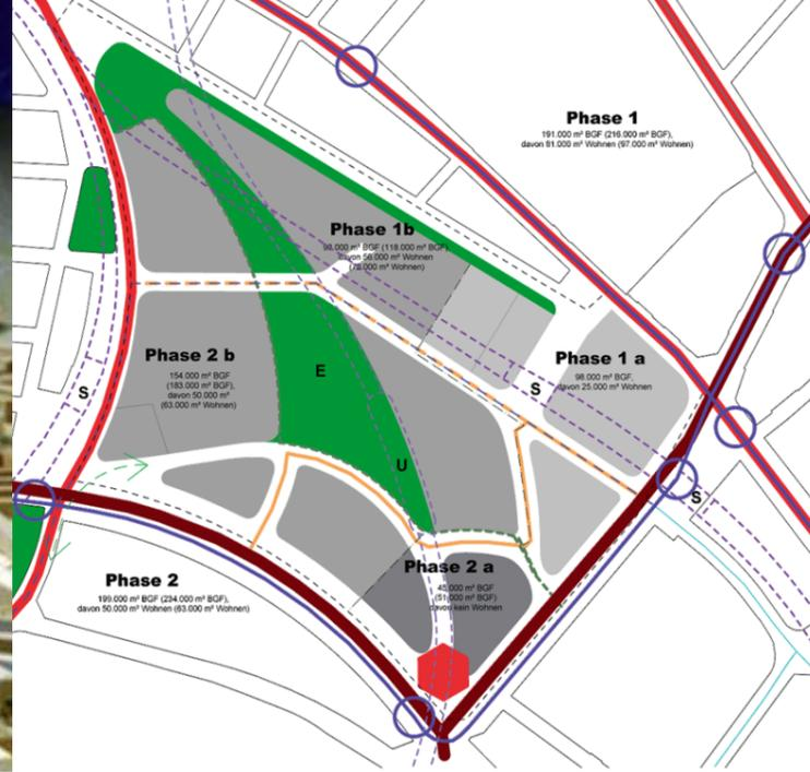
Abb.45 Strukturplan Aspang 2003 mit Planungsphasen und Verkehrskonzept
