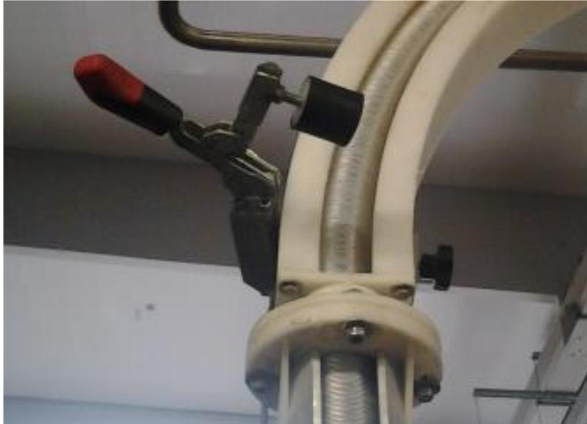
**Abbildung 31: Deckelrückhaltevorrichtung von Dose 7**
