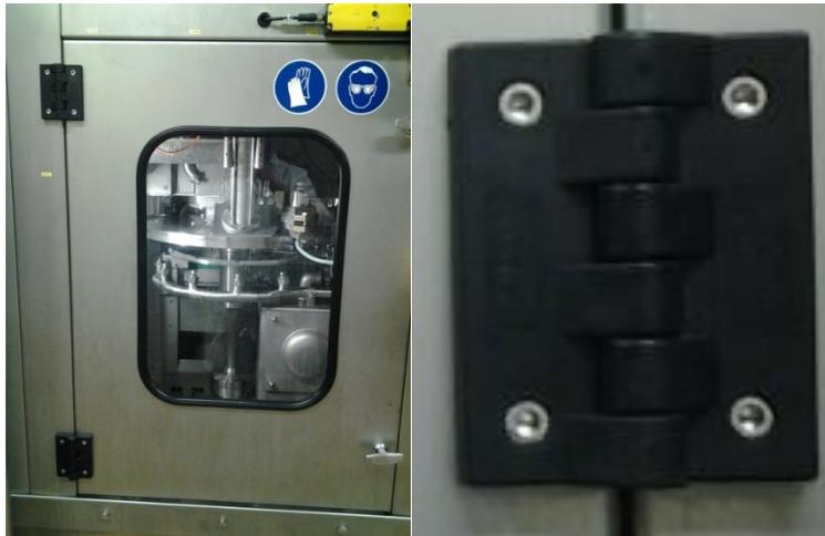
Abbildung 34: Türscharniere am Verschleißer
