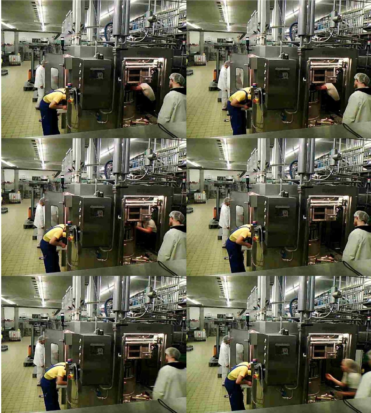
**Abbildung 17: Ausschnitt der Bilderreihe aus der Aufnahme während dem Ausbau der Führungsschienen**
