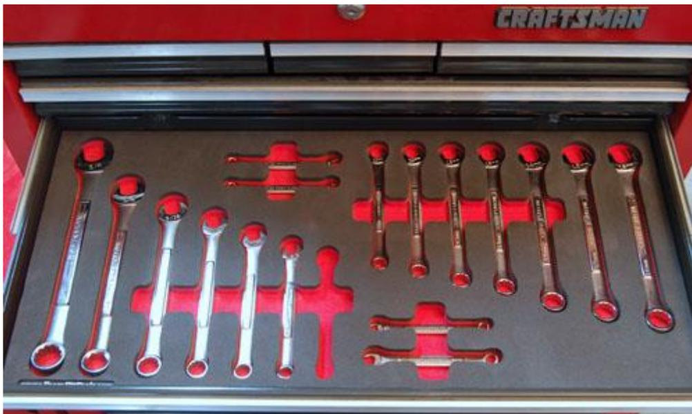
Abbildung 5: Shadow Tool Box mit einem fehlendem Gabel-Ringschlüssel<sup>26</sup>
