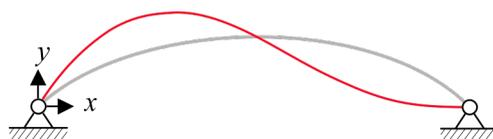
**Abbildung 5.26:** Fundamentale Eigenform an der Stabilitätsgrenze des in Abb. (5.24) dargestellten Kreisbogens
